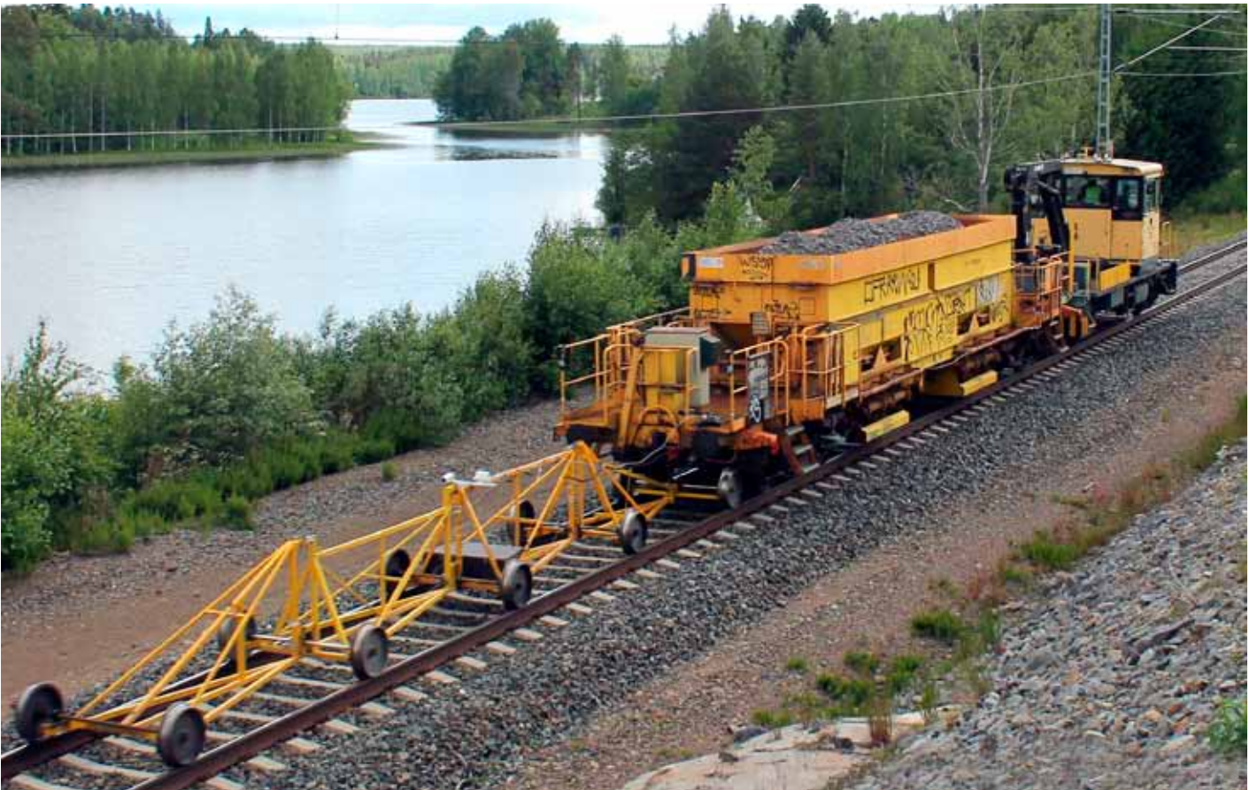
Kuva 1. Radan joustomittaus käynnissä Lielähti-Kokemäki-rataosalla. Sepelivaunuun kiinnitetyllä mittauslaitteella voidaan arvioida radan ominaisuuksia.
