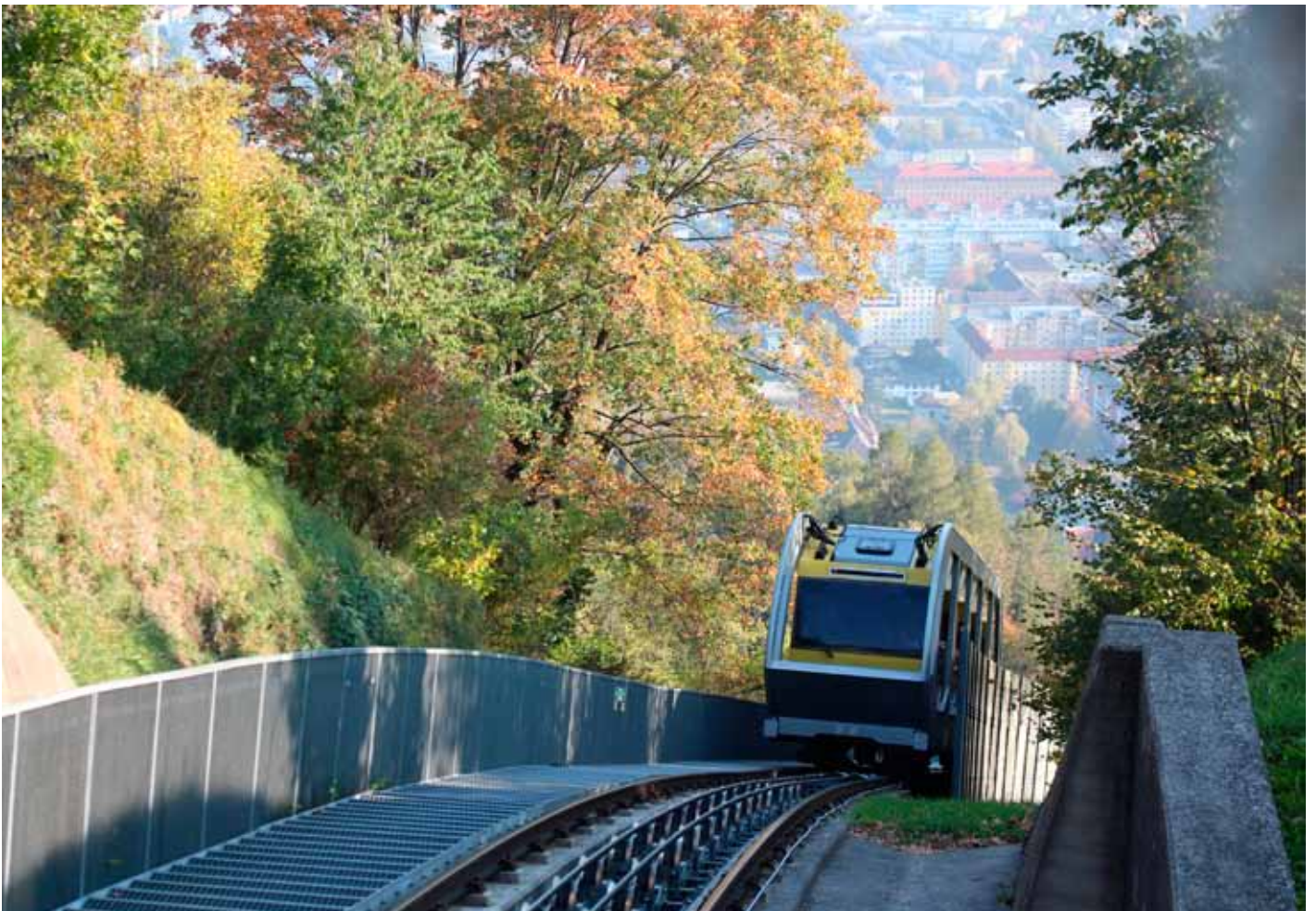
Funikulaarin radan vino kiskonjatkos, joka takaa tasaisen kulun jatkoksen yli. Valtion rataverkolla vastaavia vinoja jatkoksia on käytetty jonkin verran eristysjatkoksissa.
