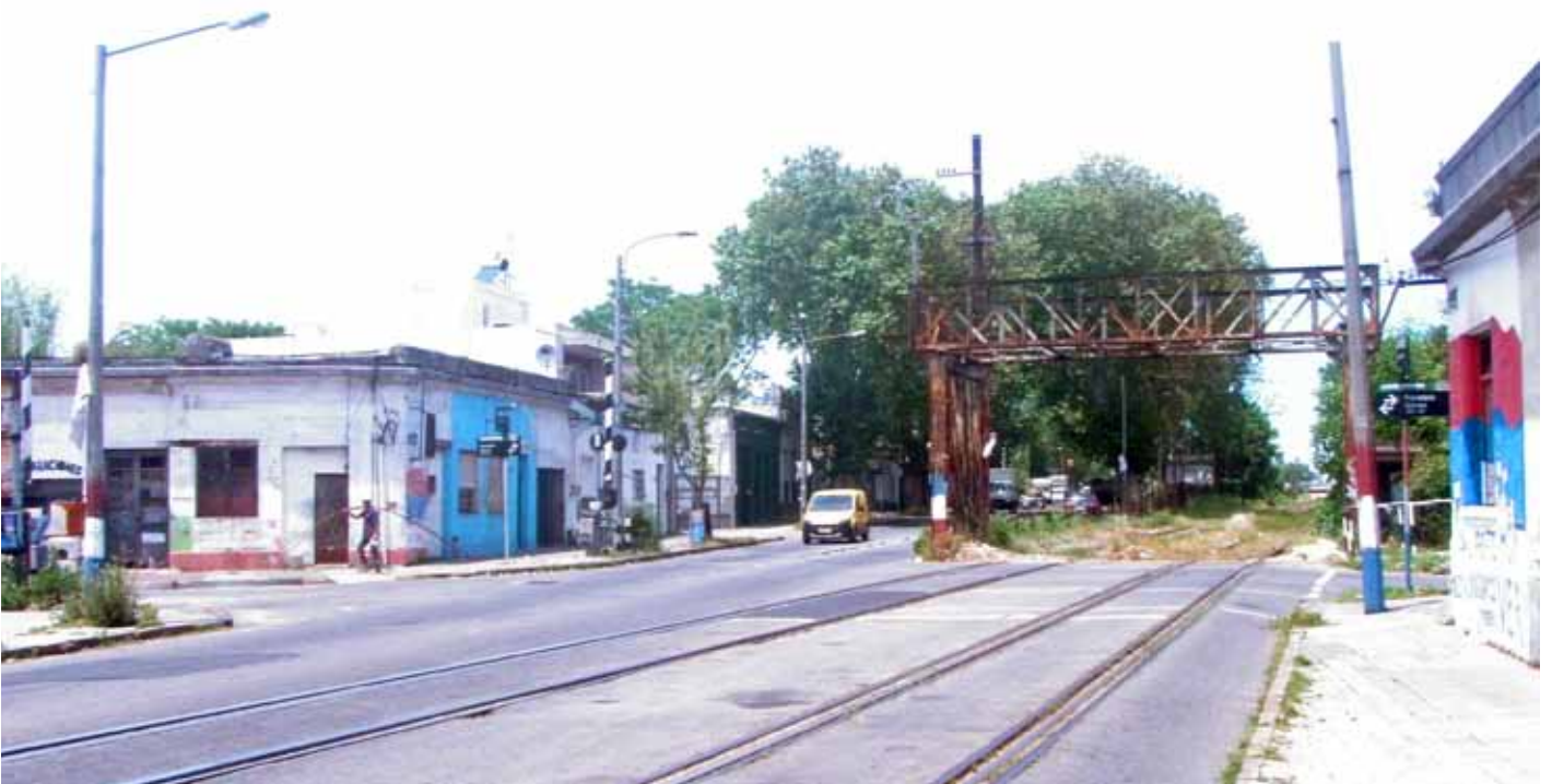
Kuva 9. Tasoristys on katuristeyksen kohdalla. Tämä kohta parannetaan painamalla rautatie kuiluun tiepinnan alapuolelle
