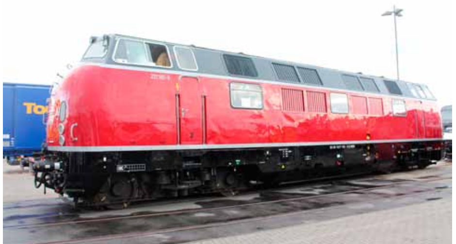
Vanha kuin uusi: täydellisesti uudistettu sarjan 221 dieselveikuri, entinen V 200.1. Ve- turissa on mm. uudet moottorit ja LED-valot.
