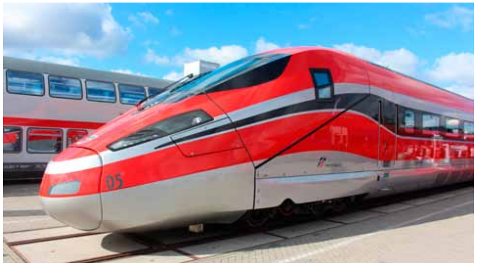
Bombardierin ja AnsaldoBredan yhteistyössä Trenitalialle valmistama Frecciarossa (Punainen nuoli) 1000 -suurnopeusjuna. Junia on tilattu 50; ensimmäisen pitäisi tulla kaupalliseen liikenteeseen keuhällä 2015. Junan teknisissä ratkaisuissa on varauduttu jopa 360 km/h nopeuteen.
