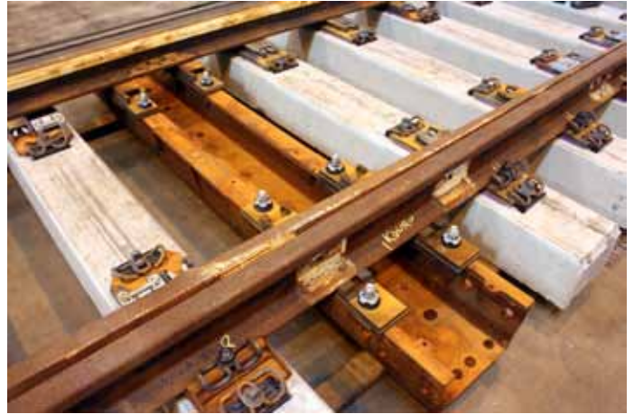
Kaukalopölkky vielä varustelemattomana ja ilman lämmitysvastuksia Pieksämäen vaihdehallilla.
