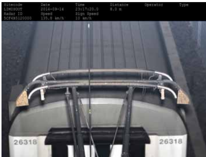
Kuva 1. Lohkeama virroittimen kontaktihiilessä.
