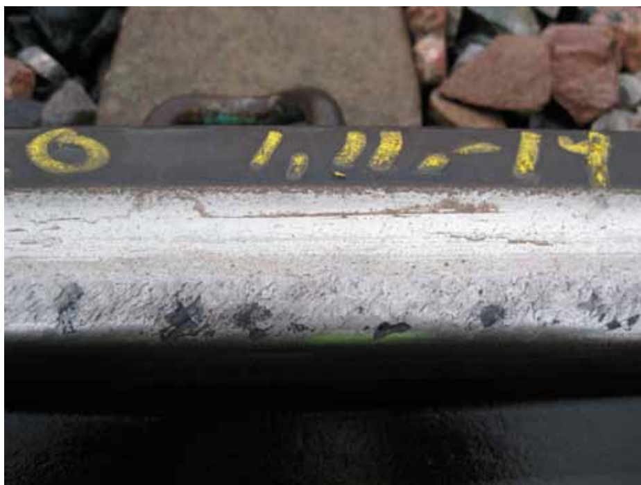
Kuva 1. Head check -säröilyä ja sen aiheuttamaa sälöilyä. Kuva Kari Huhtanen
