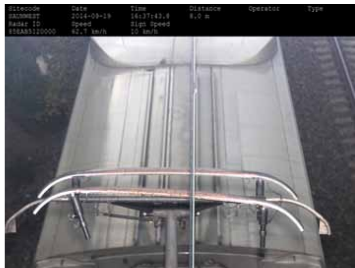
Kuva 2. Ulkoisen iskun vääntämä virroitin.
