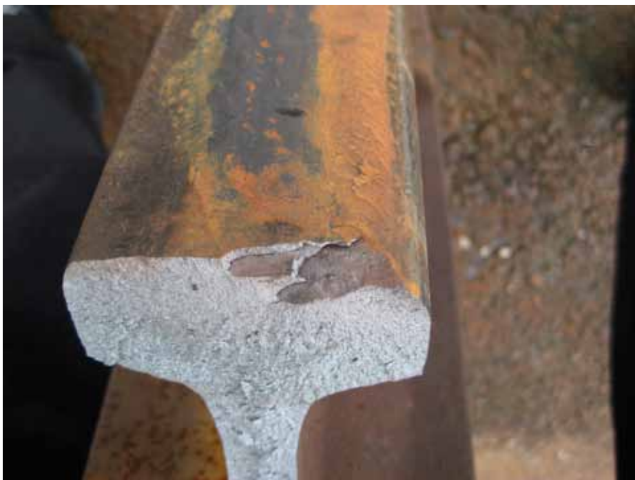
Kuva 2. Auki murrettu head check -säröilyn aiheuttama poikittainen murtuma. Kuva Kari Huhtanen
