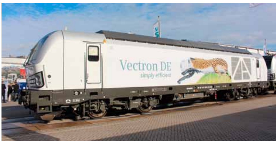
Siemensin Vectron DE on dieselsähköinen yleisveturi. Suurin nopeus on 160 km/h ja moottorin teho 2200–2400 kW.
