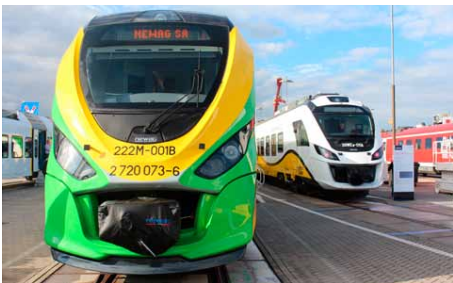
Puolalaisen Newagin moottorijuna. Vasemmalla 222M-dieselmoottorijuna ja oikealla Impuls-sähkämoottorijuna.
