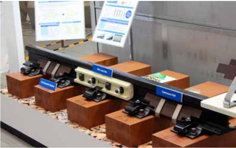
Synteettisiä ratapölkkyjä, joiden kiinnitykset ovat samat kuin puuratapölkkyissä. Ne on valmistettu puumassasta ja ureaanista laskuidun antaessa tarvittavan lujuuden.
