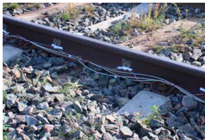
Kuva 2. Suoraan kuorman alla olevien pölkkyjen vastaanottaman kuormituksen mittausjärjestely.
