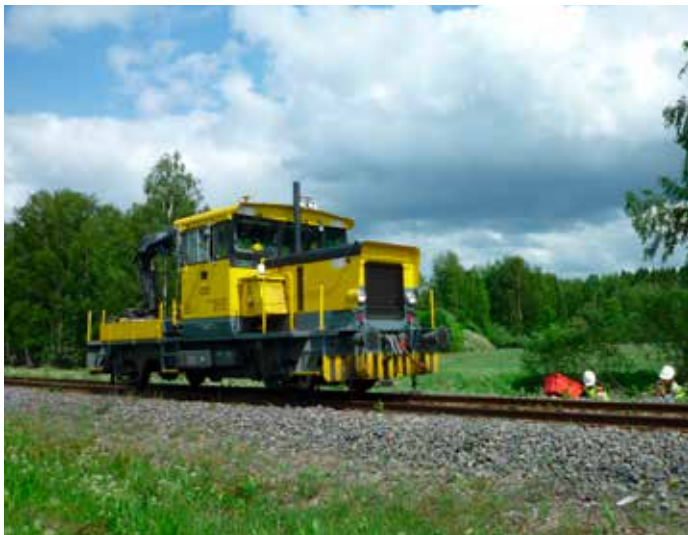
Kuva 1. Palautuvan painuman mittaus kuormittavan kaluston ollessa Tka 7.
