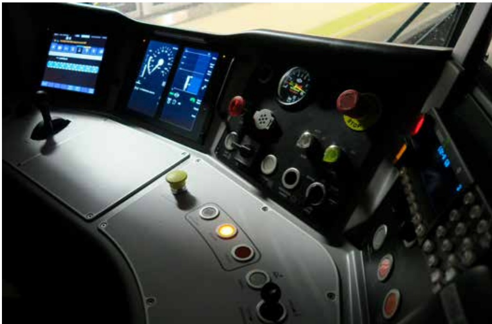
Thameslink-rata on varustettu ERTMS/ETCS-tasolla 2, ja osalla ratalinjaa on käytössä automaattiajo tasoa GoA 2. Se on puoliautomaattinen, eli vaatii kuljettajan junan ohjaamossa.
