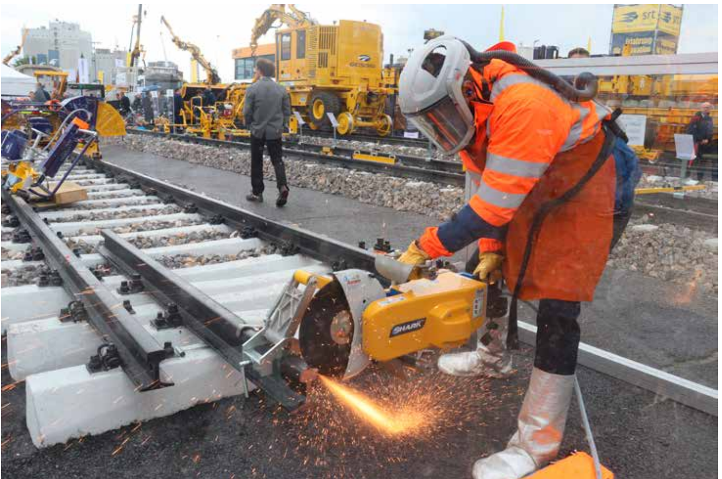
Akkukäyttöinen kiskosaha esittelykäytössä.
