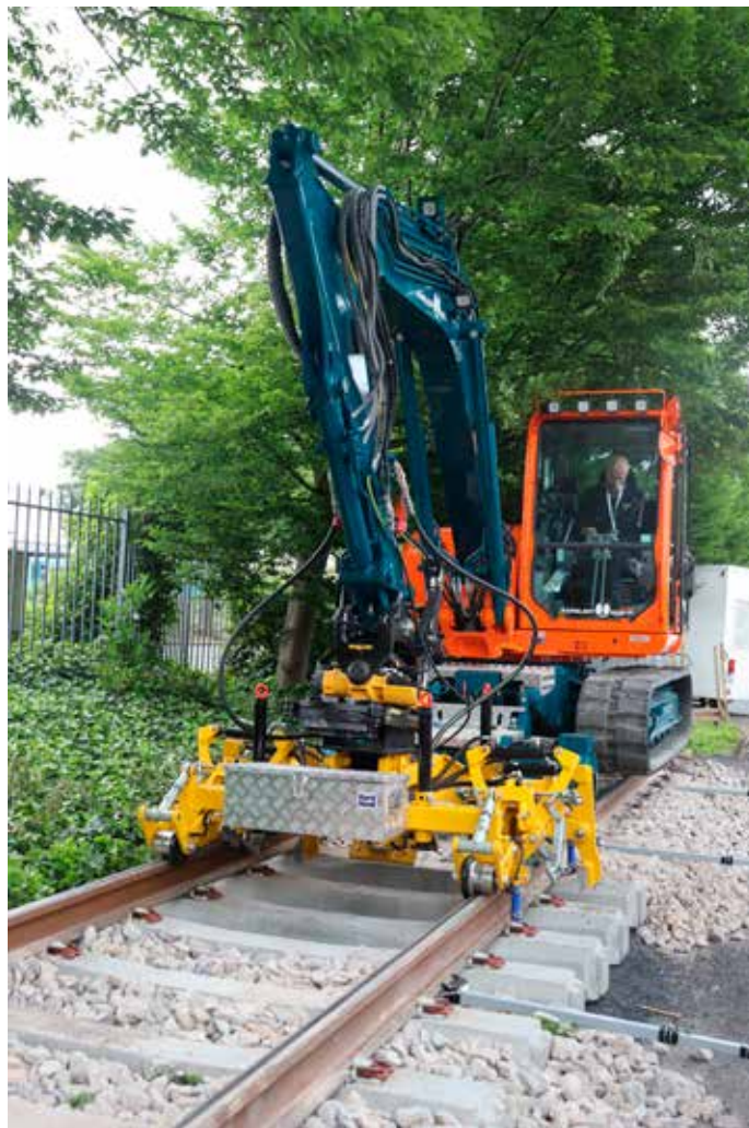
Pandrolin CD200 IQ- kone Fastclip-kiskonkiinnitysten nopeaan irrotukseen ja kiinnitykseen.
