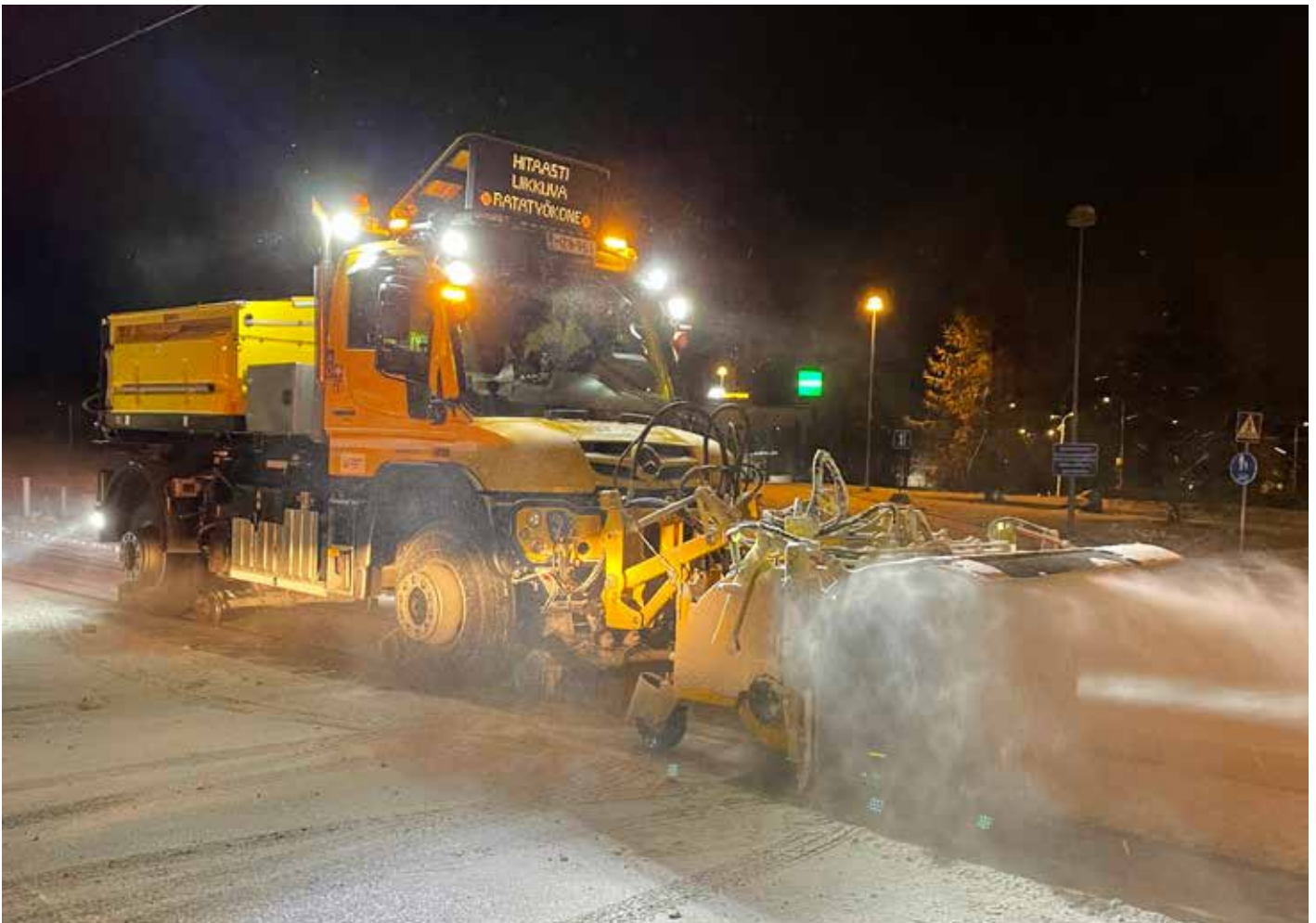
Unimogin yleisin talvivarustelu on Rascon sirotin ja Kalbacherin lumiharja.
