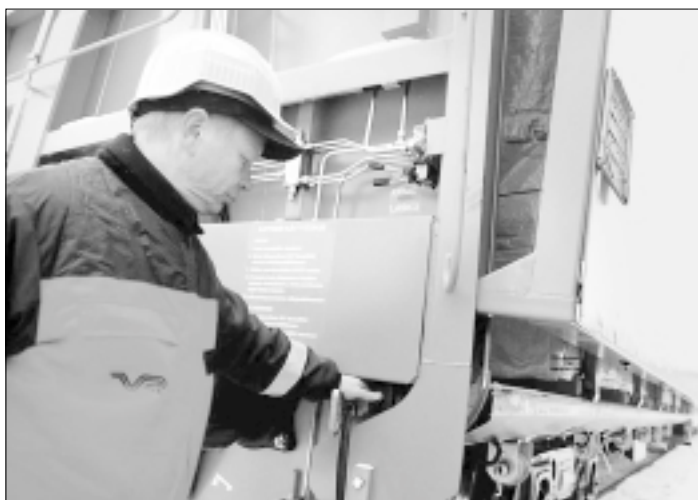
Katteen käyttö. Tuotekehitysinsinööri Esko Korpinen esittelee katteen käyttöä. Kun akkuliitin on kytketty ja suuntaventtiili on asetettu, liikkuu kate valittuun suuntaan painonapista. Vielä pehmeämpi katteen käyttö saadaan ohjaamalla käsivivulla, samanaikaisesti painonappia painaen.
