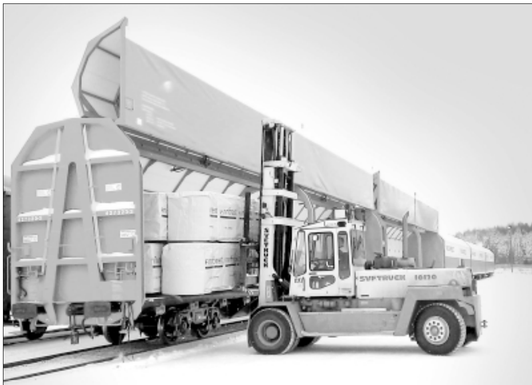
Vaunun lastaus. Kuorman käsittelyä varten saa koko Habbins-vaunun sivun auki saman aikaisesti. Katteen alareuna väistää pitkämatoistakin trukkia, masto ei ota kätteeseen kiinni.
