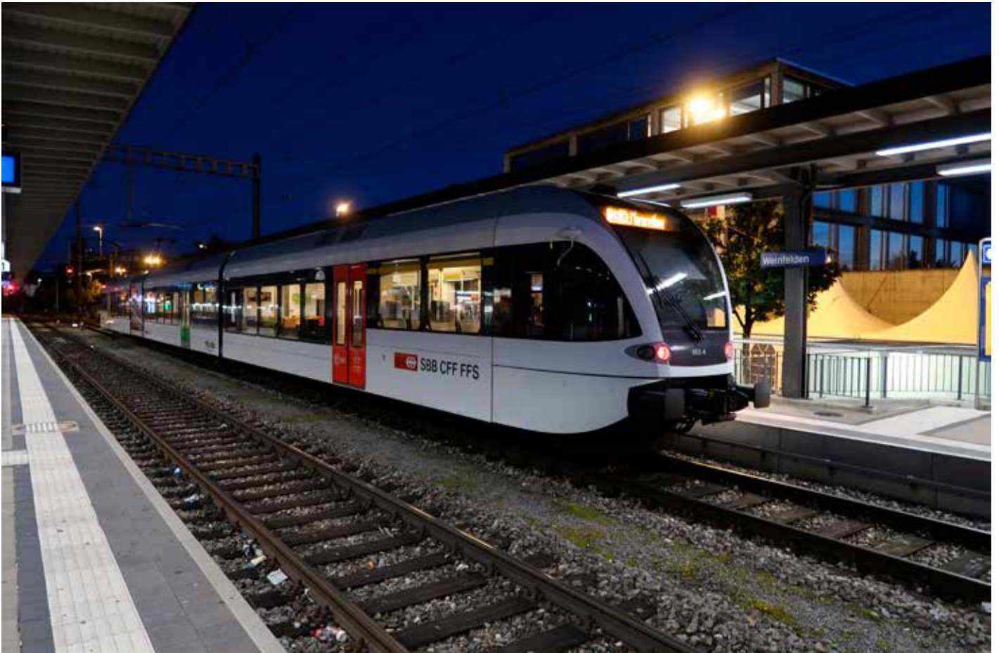
Kuva 3. Sveitsiläisen Stadler Rail AG:n valmistamat sähkömoottorijunat ovat hyviä esimerkkejä moderneista, alue- ja paikallisjunaliikenteeseen soveltuvasta modulaarisesta moottorijunakalustosta. Tilaaja voi asettaa reunaehdot esim. yksikön pituudelle, istumapaikkamäärälle jne. tarpeidensa mukaan. Stadler Rail AG on toimittanut esimerkiksi modulaarisia Flirt-tuotemerkin junia rautatiealan yrityksille eri puolille maailmaa yli 2500 kpl. Kuvan Stadler Rail AG:n valmistaman GTW 2/8 RABe-sarjan junayksikön pituus on 54,5 m ja siinä on yhteensä 162 istumapaikkaa sekä 168 seisomapaikkaa. Vastaavaa konseptia voidaan soveltaa muidenkin valmistajien yksiköissä. Kuva kirjoittajan. Weinfelden, 19.9.2023.
