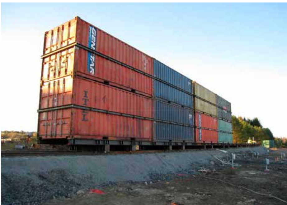
Kuva 2. Perniön sorrutuskokeen ”juna” rakenteilla.
