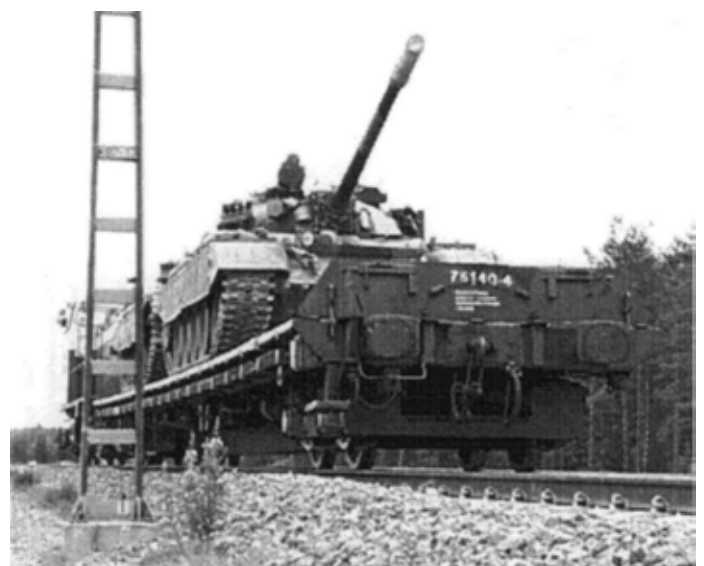
Kuva 1. Suurempien akselipainojen vaikutuksia testattiin Korialla käyttämällä kuormana raskasta kalustoa. (kuva: RHK A5/2000)
