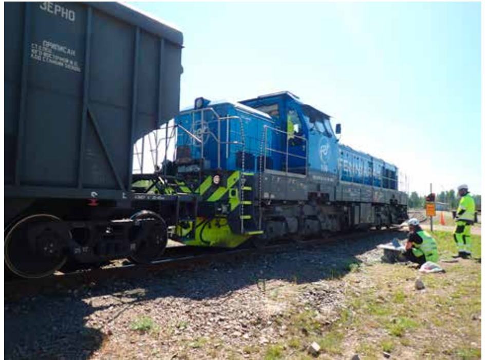
Kuva 5. Erilaisten kalustojen aiheuttamien poikittaisvoimien mittaus käynnissä Kouvolan ratapihalla.
