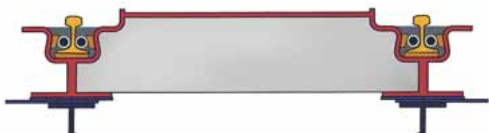
Poikkileikkaus sillan kansirakenteesta ERS-kiskonkiinnityksellä.
