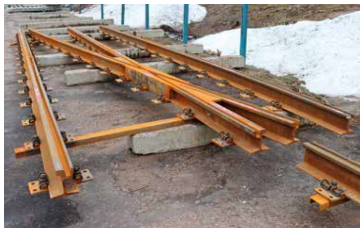
Pirkkala–Linnainmaa-raitiohankkeelle toimitettavan urakiskovaihteen YV60R2-50-1:6-V risteys ja vastakiskosovitukset odottavat vaihteen kokoonpanoa. Raitiotievaihteiden teräsosat on valmistettu konsernin tehtailla Puolassa. Osat on yksilöity jo valmistuksessa; nämä osat menevät Tampereelle Hatanpään valtatie vaihteeseen V 188.
