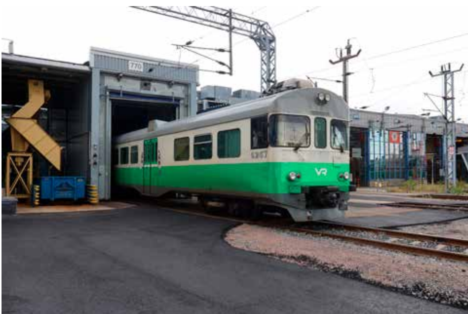
Sm2-yksikkö, kuvassa ensimmäisenä ohjausvaunu EioC 6267 on käynyt pyöräsorvissa ja valmistautuu lähtemään Ilmalan ratapihalta linjalle. Kuva: Jouni Kiviniitty, Helsinki 5.8.2025.
