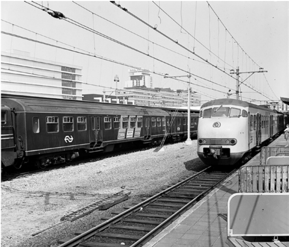
NS:n (Nederlandse Spoorwegen) 2-vaunuinen sähköjunayksikkö Plan V (vuosimalli 1964) Utrechtin keskusaseman laituriraiteella kesäkuussa 1970. Vasemmalla tuolloin kansainvälisessä liikenteessä ollut Plan W -vaunu. (Kuva: Nederlandse Spoorwegen)
