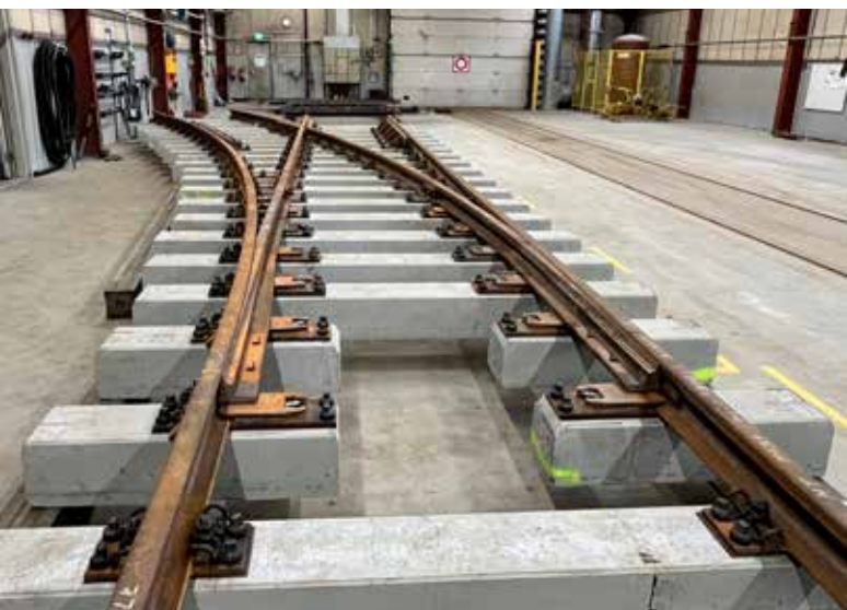
Tampereen raitioiteille Hervannan varikon laajennukseen menevä YV49E1-25-1:2,18-V valmiiksi koottuna. Vaihteen kääntölaite asennetaan vasta Tampereella.
