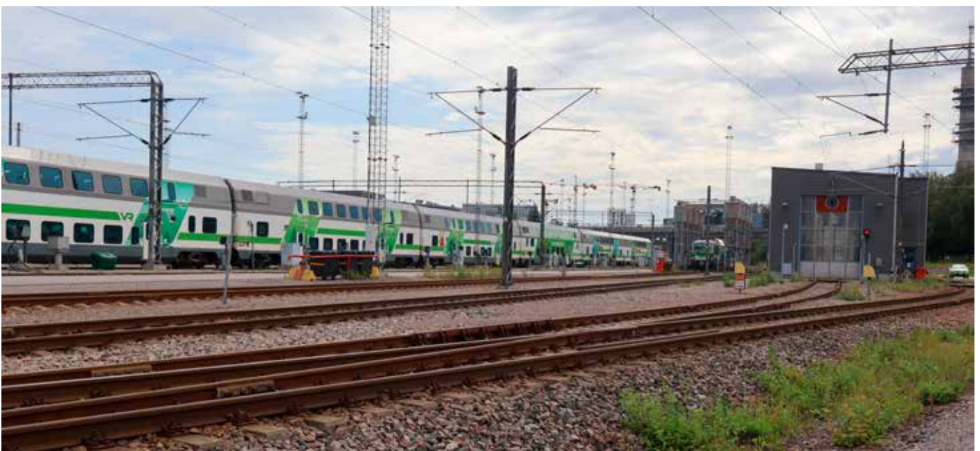
Ilmala ykkösen toimintoja. Kuvassa vasemmalla kaukojunarunkojen käyttövalmiushuoltoraiteita, edessä veturin hiekoitus sekä oikealla Pesu 2-huoltohalli. Sr3-veturi 3335 saa parhaillaan hiekkaa säiliöihinsä. Kuva: Jouni Kiviniitty, Helsinki 5.8.2025.
