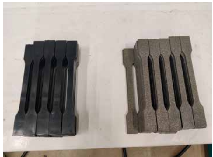
Kuva 2: Ruiskuvaletut koesauvat laboratoriotestejä varten (mustat ABS ja harmaat nestepakkauskartongin pulpperoinnin rejekti).
