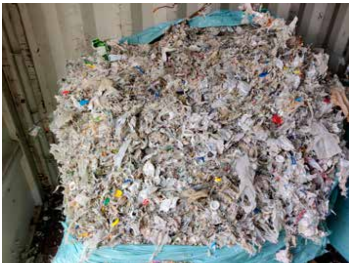
Kuva 1: Nestepakkauskartongin pulpperoinnin rejektiä.
