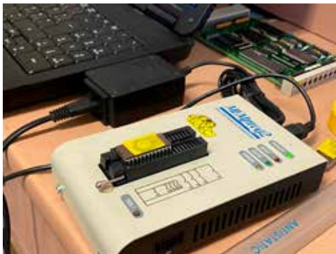
Kuva 4. Juurikorven ZUS-ala-aseman EPROM-ohjelmointi käynnissä.
