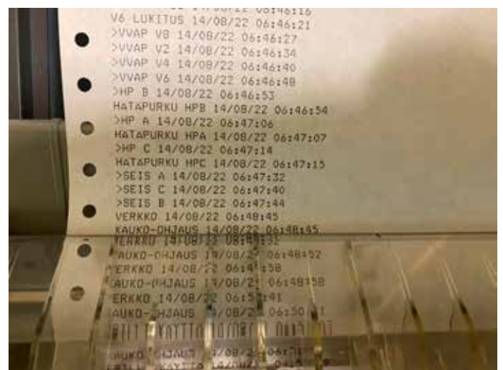
Kuva 10. Inkeröisissä sijaitsevan Juurikorven ZUS-häiriökirjoittimen tulostetta Haminan haaran tilapäisen liikennöintimallin käyttöönottoaiheessa.
