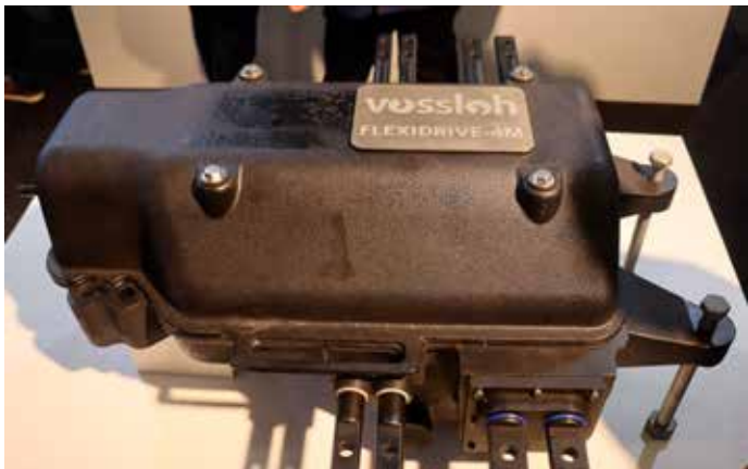
Vosslohin Flexdrive -4M -vaihteenkääntölaite, joita on Suomessaakin yksityisraiteilla.
