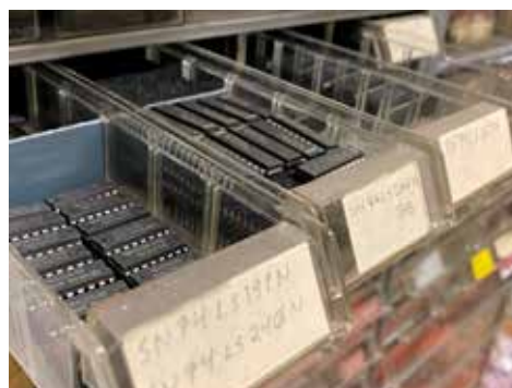
Kuva 3. Oulun turvalaitekunnossapidon laboratoriossa tallessa olevia mikropiirejä, joita käytettiin ZUS-piirikorttien korjauksessa.
