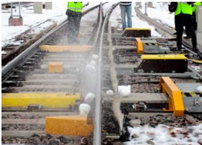
Kuva 1. Airjet-järjestelmän testausta Havukosken erkanemisvaihteilla (kuvassa vaihde 212) 13.2.2015. Vaihteen kielen ja tukikiskon väliin asetetut lumilohkareet ovat juuri sinkoutumassa pois paineilman vaikutuksesta.
