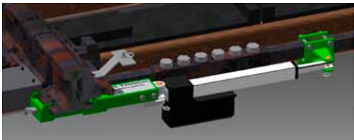
Kääntölaitteen moottori asennettuna kiialukkovaihteeseen. Kuva Tero Savolainen
