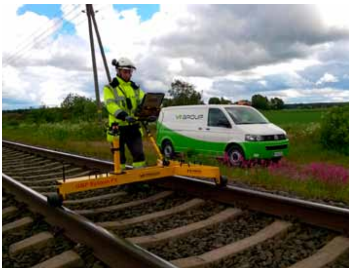
Kuva: Raidegeometrian nykytilan kartoitus mittausvaunulla (kuva VR Track OY)
