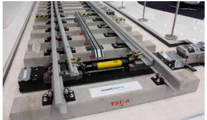
Voestalpinen TSF-A-vaihte Spherolock-lukkoineen ja Ecostar-kääntölaitteineen. Kuva Markku Nummelin.
