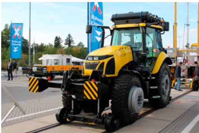
Puolalaisvalmisteinen Orion 9C-raidetraktori. Tässäkin koneessa on myös junajarrut vau- nujen jarruttamiseen. Kuva Kalle Renfeldt.
