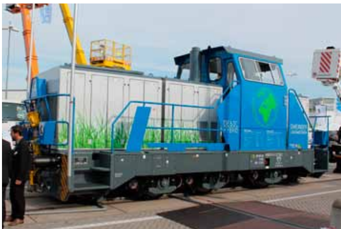
Gmeinderin DE60C -hybridivaihtoveturi. Kuva Kalle Renfeldt.
