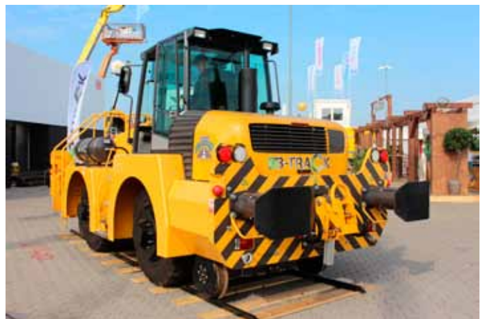
Irlantilaisen TRRF:n B-Track 16 -kiskopyörä-vaihtotyökone. Radio- ohjattu 16 tonnia painava "veturi" pystyy vetämään 1600 tonnin junakuorman. Kuva Markku Nummelin.
