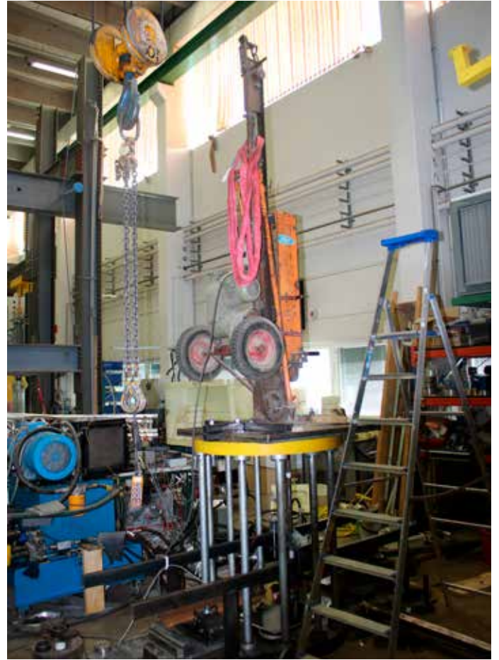
Kuva 3 Iskukuormituskokeissa käytetty kuormituslaitteisto.
