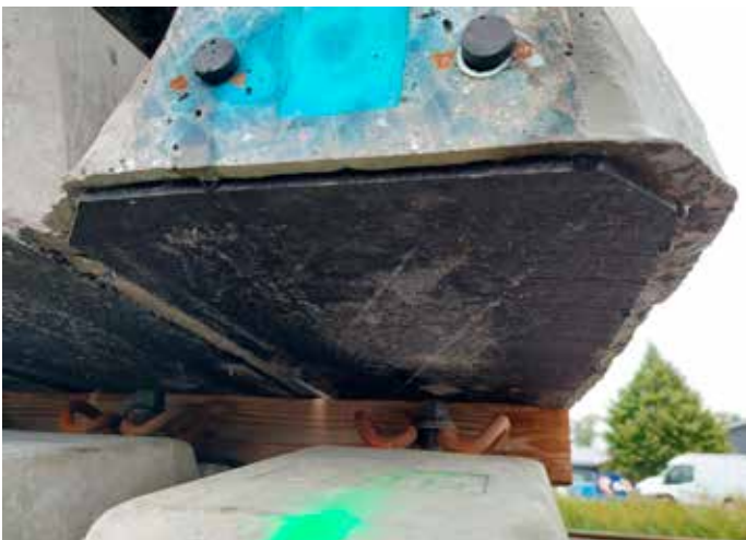
Kuvassa Pandrol, tyyppi1, USP-R-07e, asennettuna Bp99-pölkkyyn (tämä kappale ns. reikäpölkky).
