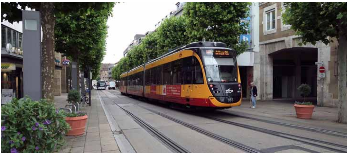
Linjan S42 vaunu Heilbronnin keskustan Kaiserstraßella. Samalla ET2010-tyypin vaunulla liikennöidään Heilbronnin keskustan katuraitiotiellä sekä Saksan liittotasavallan yleisellä rataverkolla – jopa 100 km/h nopeudella ja kahdella eri sähköistysjärjestelmällä. Kuva kirjoittajan. Heilbronn, 13.6.2018”.
