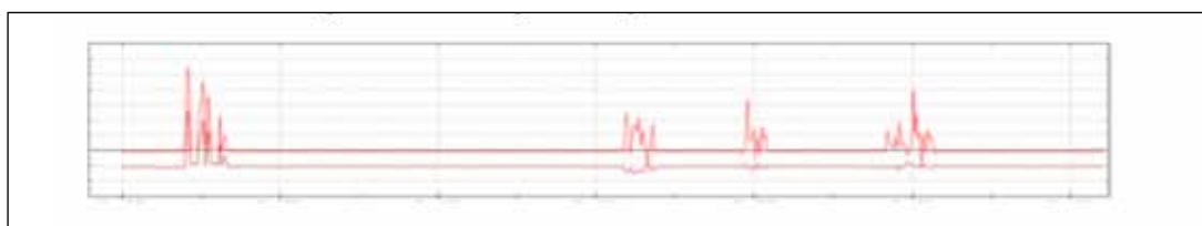
Kuva Mittaus rataosalta, jossa vain yksi juna päivässä tarvitsee suodatinta (loisteho alempi ja pätöteho ylempi käyrä)
