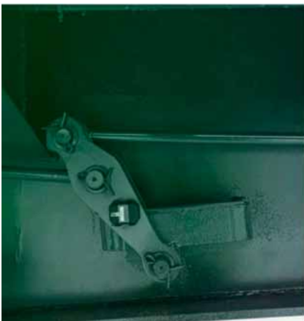
Kuva 2. Ruuvijarrun asennon tunnistaminen
