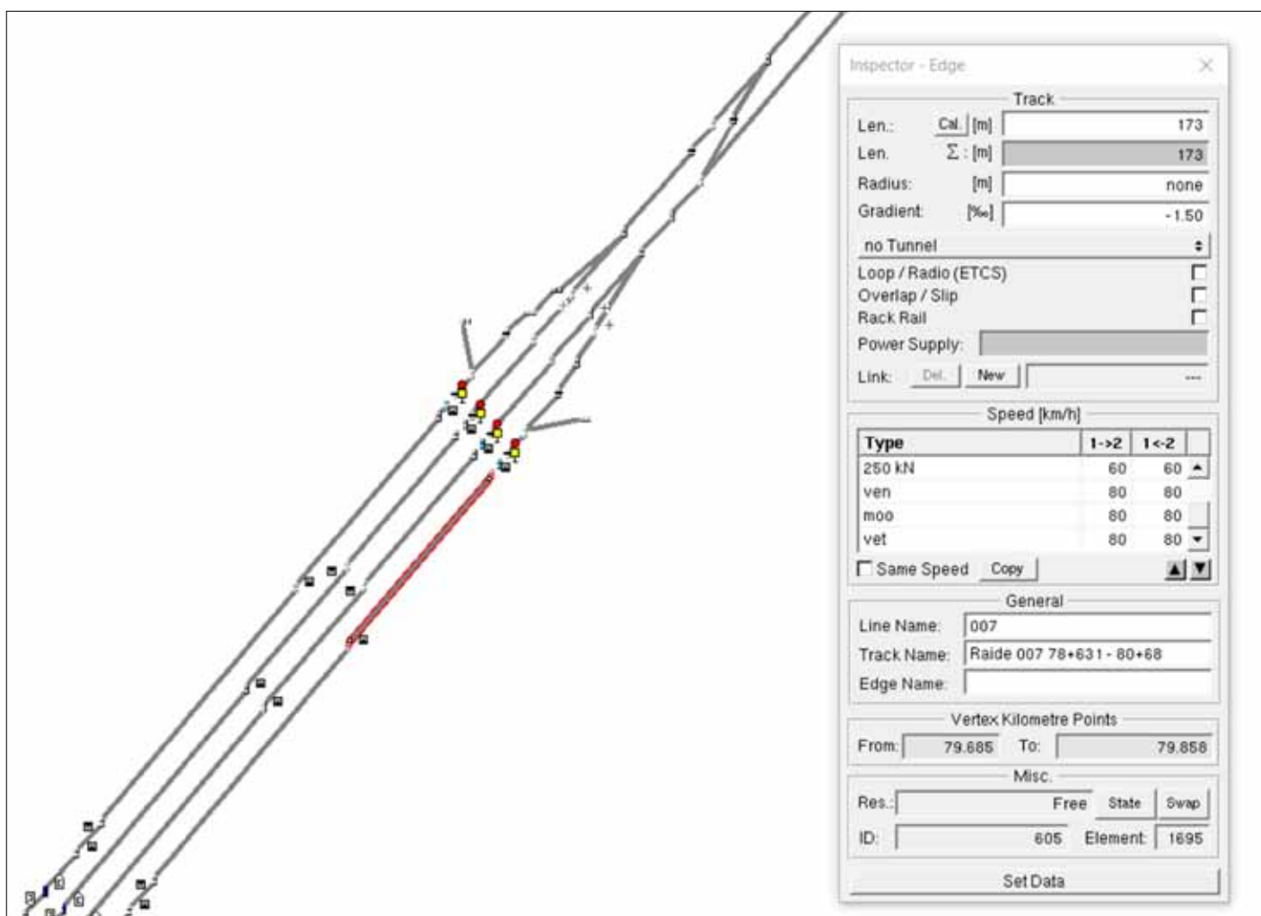
Kuva. Esimerkki työkalulla luodusta Opentrack-ohjelmiston inframallista (Hennan liikennepaikka oikoradalla) ja radan ominaisuustiedoista.
