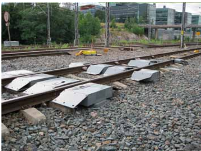
Kuva 1. Lasermittausasema (vas) ja pyörän poikkileikkaus mittausten pohjalta (oik).
