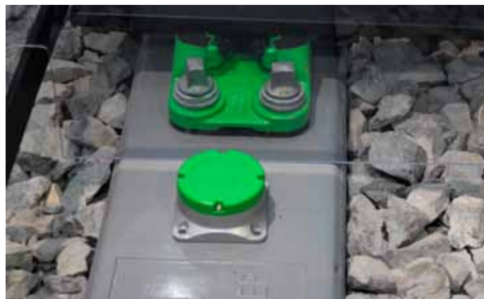
Digitaalista kunnonvalvontaa: vapaasti asennettava sensori vaihdepölkyn päällä.
