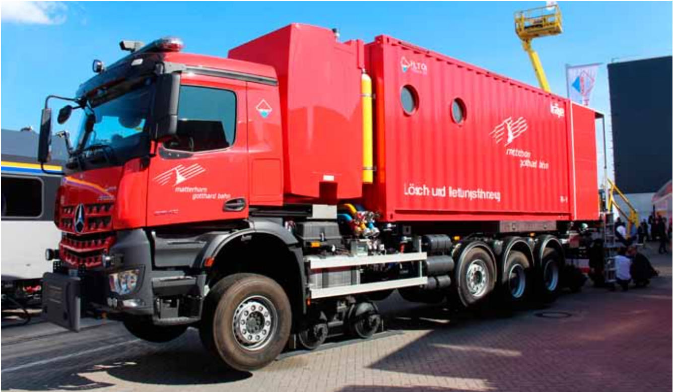
Matterhorn–Gotthard Bahnin raskas kaksitiesammutus- ja pelastusajoneuvo. Raideleveys on 1000 mm.
