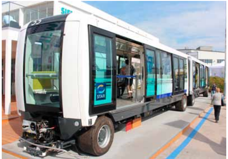
Siemensin Cityval-peplemover -automaattijuna Ranskaan Rennesin metrolinjalle B. Junien nopeus on 80 km/h. Rata avataan 2020. Sen pituudeksi tulee 12,7 km.
