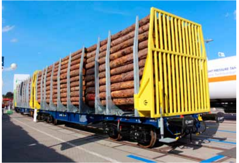
Innofreightin raakapuuvaunu. Näissä vaunuissa pyritään hyödyntämään kuormauttuma mahdollisimman tarkoin.
