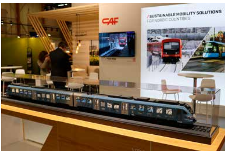
CAF:n osastolla esille tuotiin Suomeen toimitettujen metrojunien hyvä talvikäytettävyys. Pienoismalli esittää puolestaan Saksaan NWL:lle (Nahverkehr Westfalen-Lippe) toimitettavia Civity BEMU-akkumoottorijunia. Akut ladataan kattovirroittimen avulla sähköistetyillä radoilla tai erityisillä latausraiteilla.
