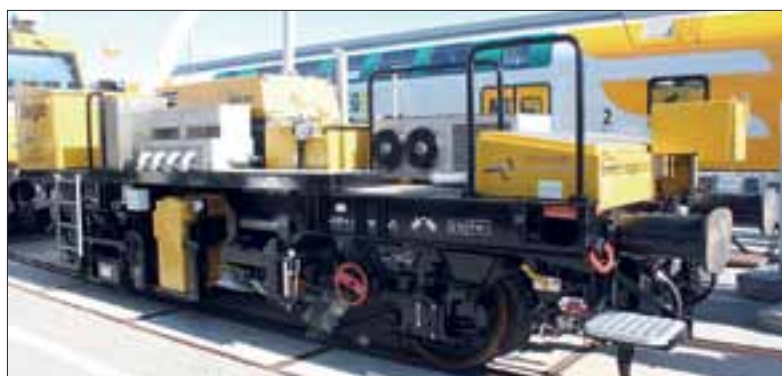
Eurailscoutin hinattava vaihteenmittausvaunu. Mittaukset tapahtuvat optisesti.
