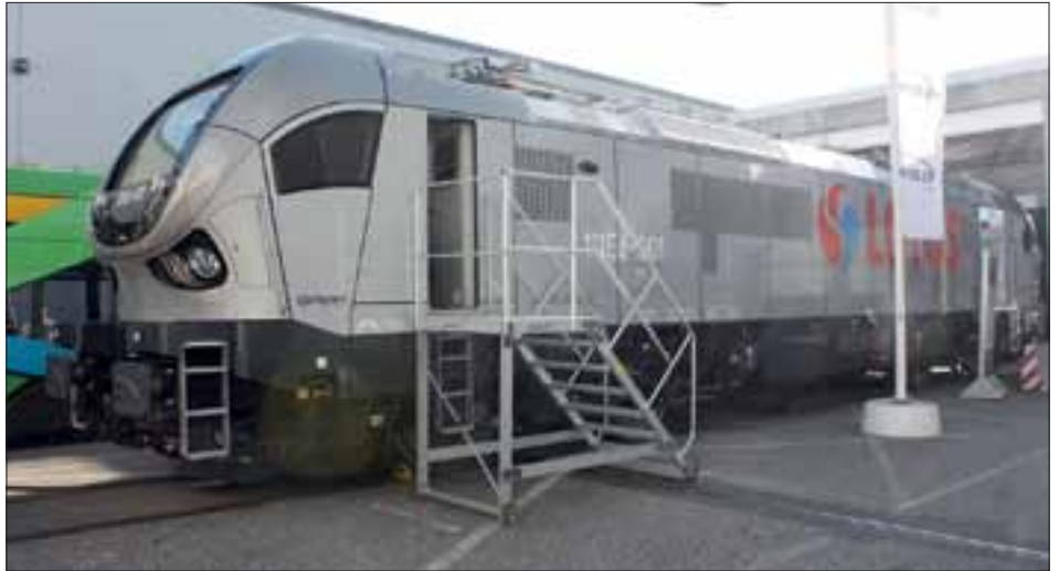
Puolalaisen PESA:n valmistama Marathon Ed Gama –sähköveturi 3 kV tasavirta –sähköjärjestelmälle. Teho on 5600 kW. Veturi on varustettu apudieselkoneella sähköistämättömillä sivuraiteilla liikennöimistä varten. Päiden muotoilu on tyypillistä PESA:lle.
