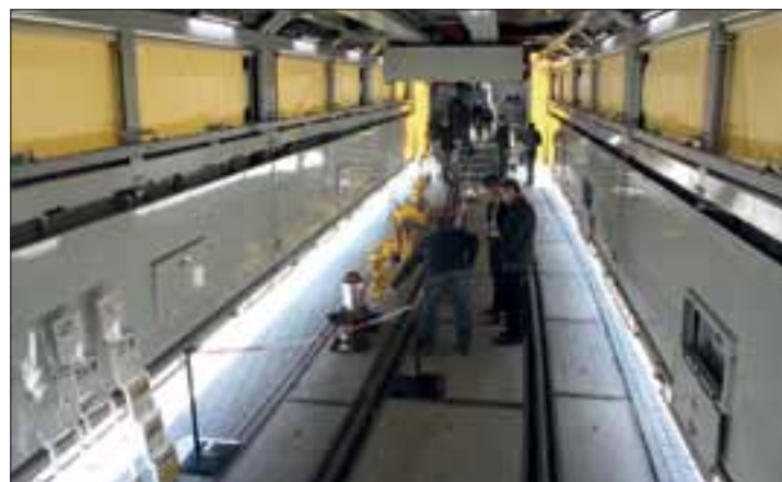
Norjan kunnossapitojunan keskimäinen lattiaton työvaunu.
