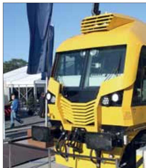
Linsingerin suurnopeushiontajuna. Myös Voss (Speed Grinding) -juna.
