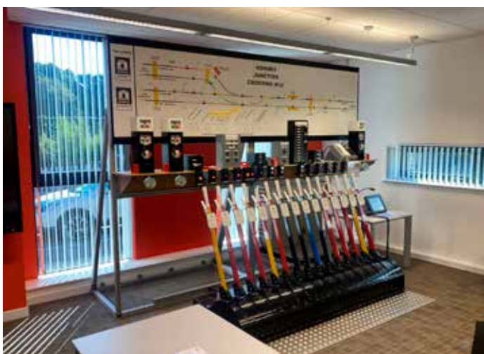
Kuva 4. Kankiasetinlaitteet käyttökoulutuspaikalla on vastikään uusittu. Järjestelmässä on simuloituna ja opettajan pisteellä tietokoneavusteisesti ohjattuna naapuriliikennepaikat manuaalisine suojustusriippuvuuksineen.
