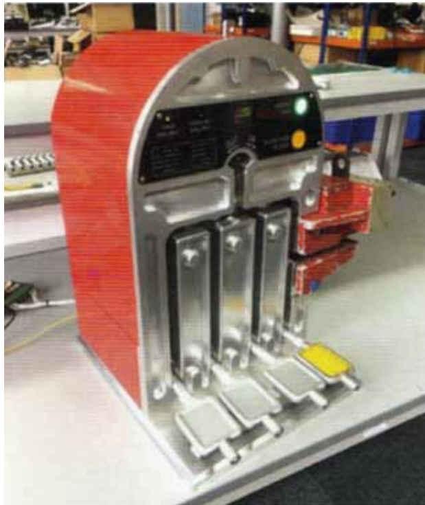
Kuva 6. Brittiläinen IP-yhteyttä käyttävä modernisoitu ”kapulasuojastuslaite”. Kuva IRSE NEWS lehti 3/2019
