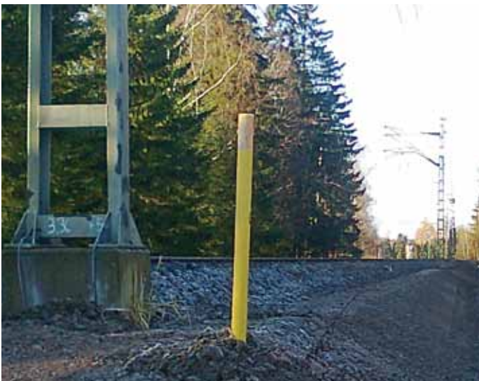
Kuva 1. Kiintopiste ratapenkassa. Pisteen päällä on usein keltainen muovinen näkyvöityskappale. Penkassa olevat pisteet ovat herkkiä roudan ja ratatöiden aiheuttamille liikkeille.
