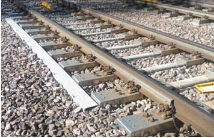
VEKU -järjestelmä pyörien rataa aiheuttamien voimien mittaukseen
