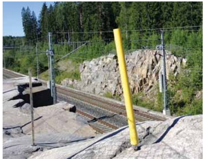
Kuva 2. Kiintopiste on kallioon porattu rautaputki näkyvöityskappaleen alla.
