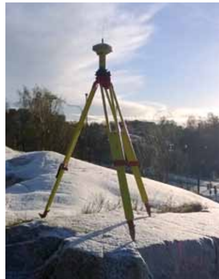
Kuva 4. Staattinen kiintopisteen mittaust GNSS satelliitti vastaanotimella. Piste on kolmijalkojen alla oleva teräksinen kalliopiste.
