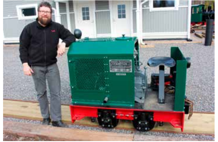
Robert Sand ja upeasti kunnostettu Diema vuodelta 1969. Dieman rakennusnopeus on 8 km/h, mutta sitä on koeajettu 9 km/h nopeudella. Kuva Markku Nummelin
