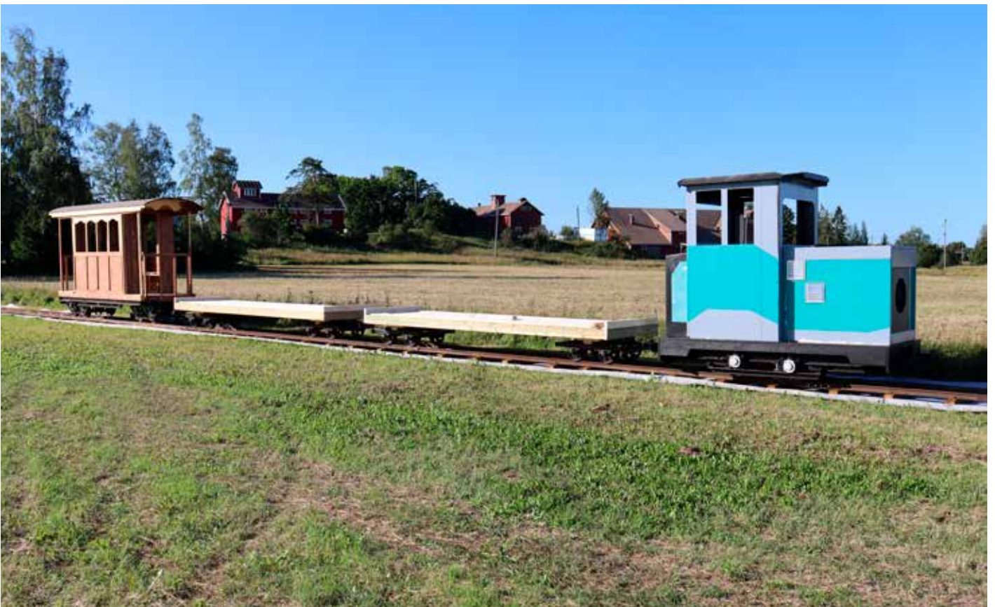
Sekajuna Kimonkylässä. Pyöräkertoja ja Move1-veturin alustaa lukuun ottamatta koko kalusto on omatekoista. Kuva Markku Nummelin
