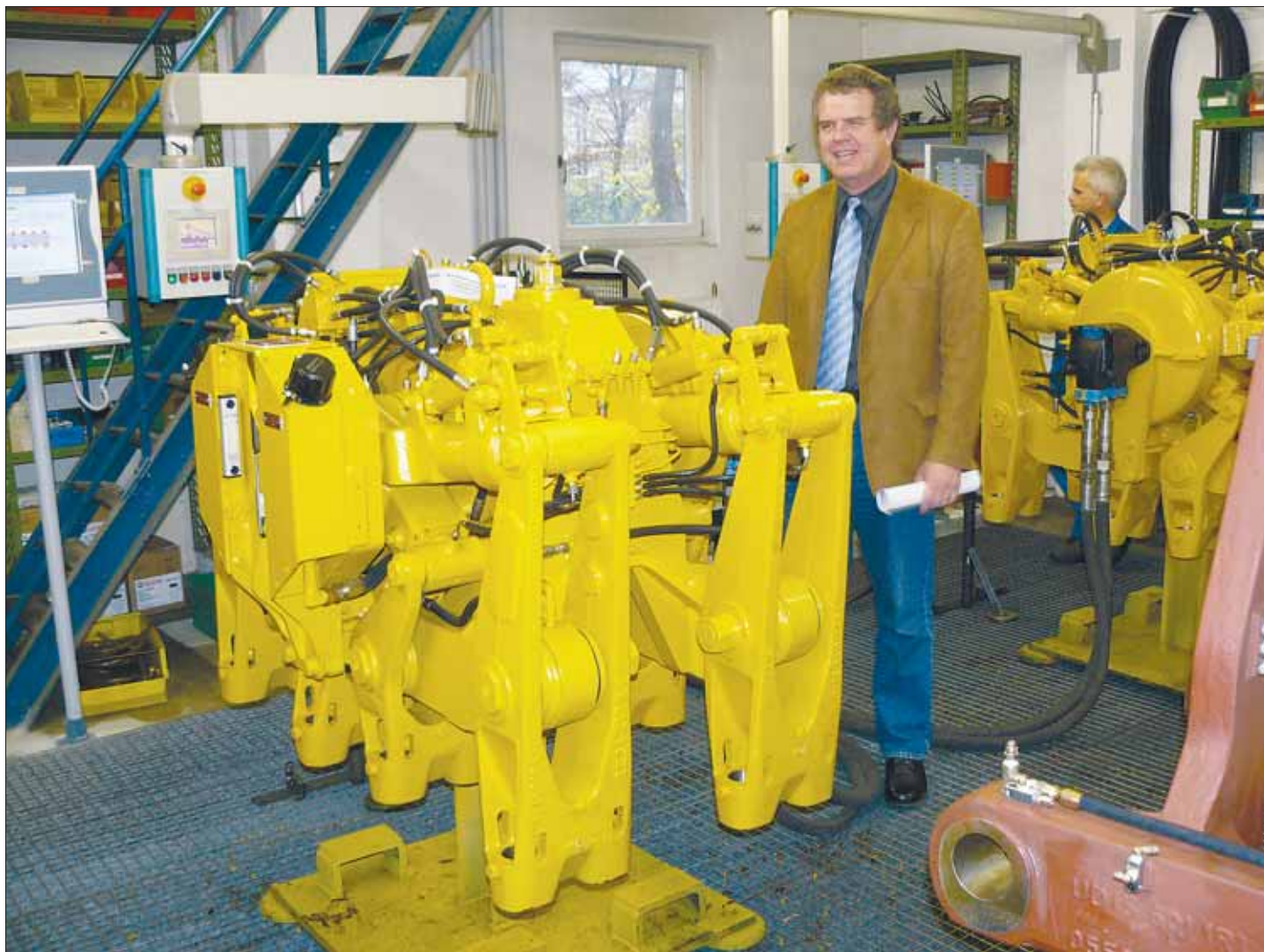
Koekäytön vaatimat hydraulikkapumput oli asennettu alapuoleiseen kellaritilaan, näin koekäyttöpaikka oli saatu lähes meluttomaksi
