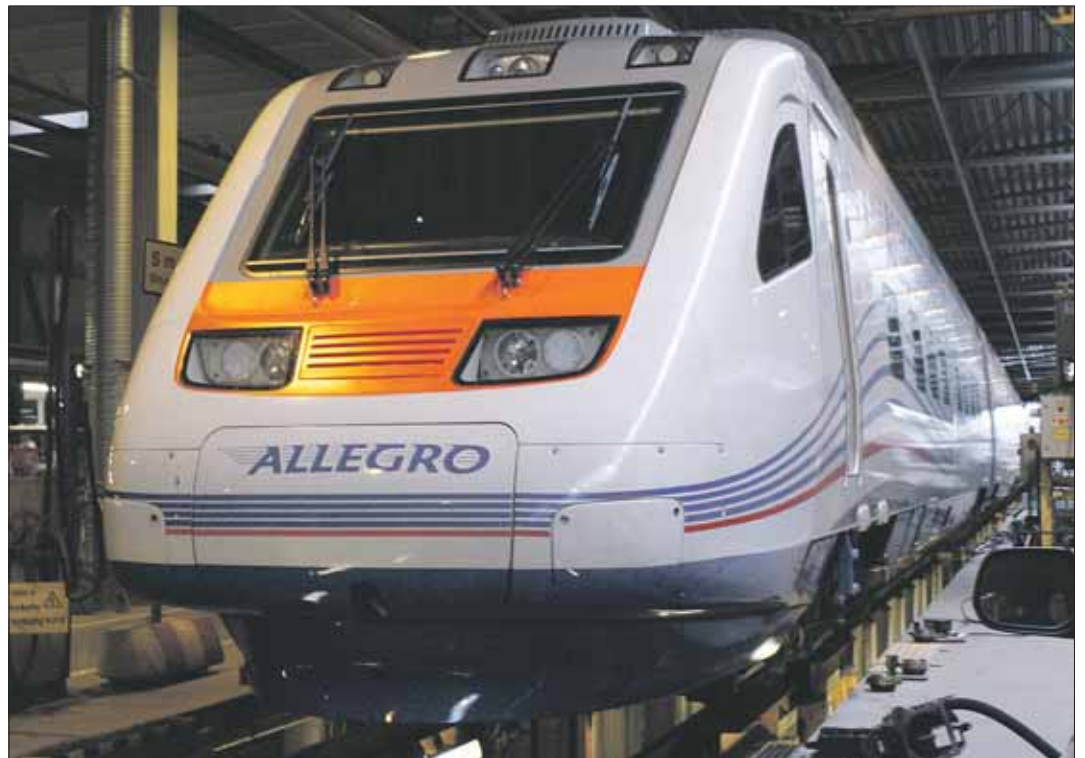
Allegro junayksikkö koostuu seitsemästä vaunusta. Pendolinoon verrattuna junassa on yksi vaunu enemmän. Tähän vaunuun on sijoitettu mm. viranomaisten tarvitsemat tilat.
