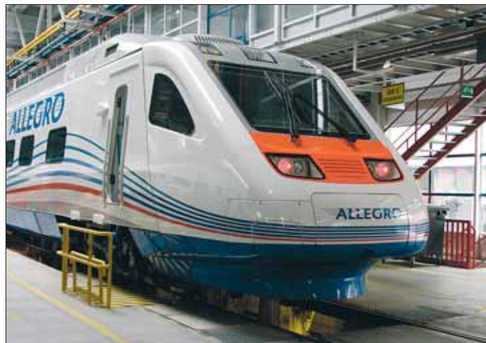
Allegron ulkovalojen tulee täyttää sekä suomalaiset että venäläiset vaatimukset, junassa täytyy olla normaalia enemmän valaisimia. Osaa käytetään Suomen puolella ja osaa Venäjällä.
