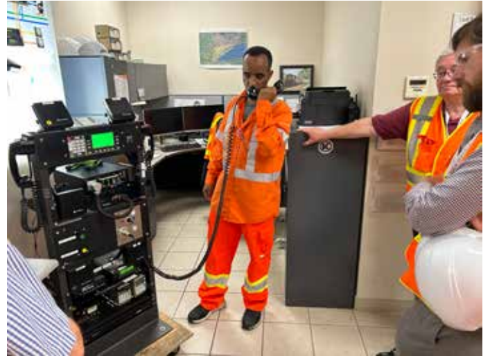
Kuva 12. Metrolinx-junien radioräkin esittely käynnissä. Yhteys syntyi käsiradioon.
