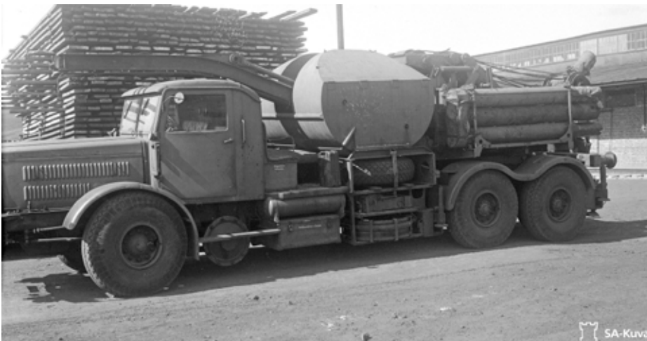
Kuva 2. Kivikurun matkakertomukseen sisältyvä kuva Harkovin materiaalivarastolta. Kuvassa kiskoilla ja maantiellä kulkeva kevyt nosturiajoneuvo. SA-kuva.
