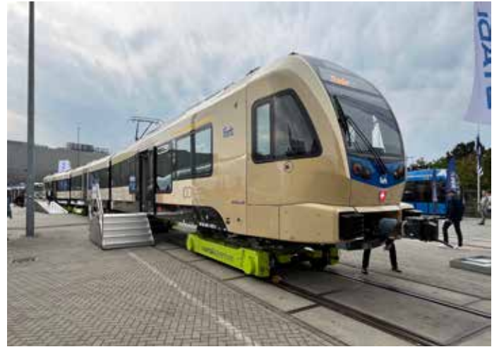
Stadlerin "Sadan laakson rautatielle" eli FART:lle (Ferrovie Autolinee Regionali Ticinesi) valmistama 1000 mm raidelevyden juna Railadventure-yhtiön LocoBuggy-siirtoteleillä. Junia on tilattu sekä kolmi- että nelivaunuksena.
