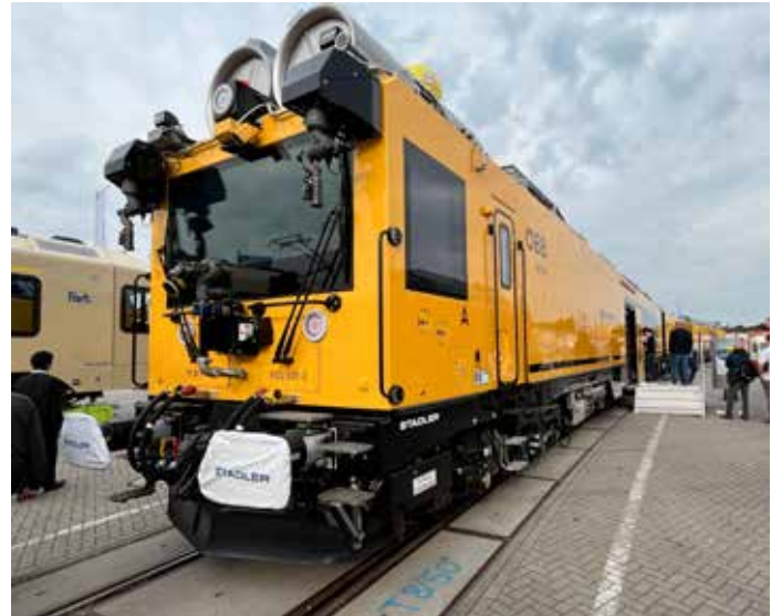
Stadlerin valmistama Servicejet-juna X122 005 Itävallan ÖBB Infralle. Kolmivaunuista juna voidaan käyttää sekä radan kunnossapitotöissä että palo- ja pelastusjunana tunneleissa. Se voi kulkea sekä ratajohdosta sähkön ottaen, dieselaggregaatilla tai akuilla. Suurin nopeus sähkökäytöllä on 160 km/h ja hybridikäytöllä 120 km/h. Junan pituus on 68 metriä. Sillä voi evakuoita yli 300 ihmistä.
