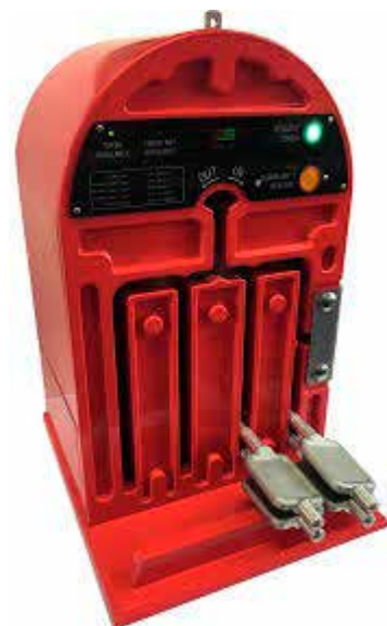
Kuva 2. Elektroninen kapulasuojustuslaite (Park Signalling)
