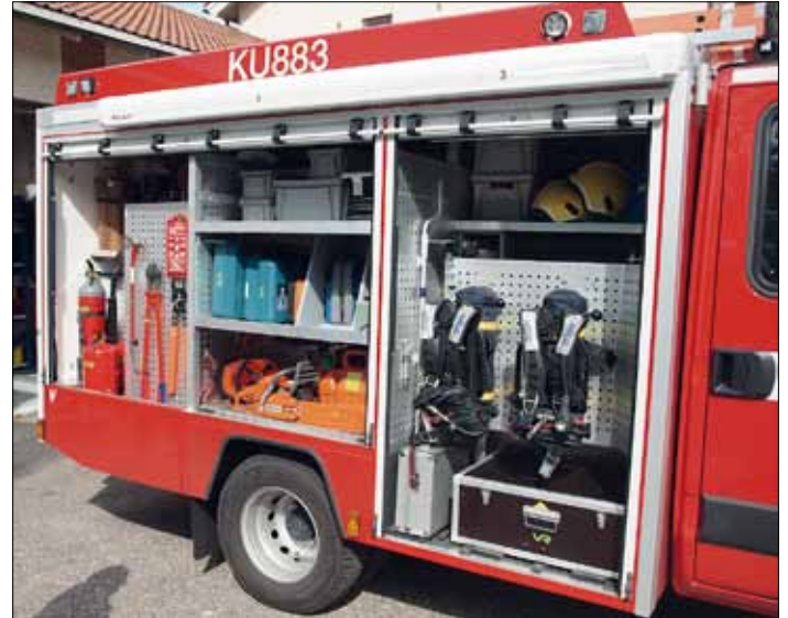
"Puhtaalla puolella" ovat puvut, paineilmalaitteet ja ensiapukalusto.
