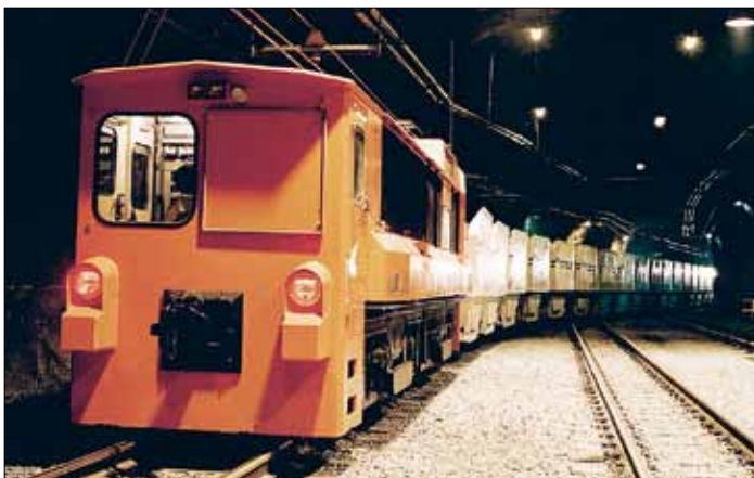
Louhittu malmi kuljetetaan kuuppahisseille kauko-ohjatuilla junilla (kuva: LKAB).
