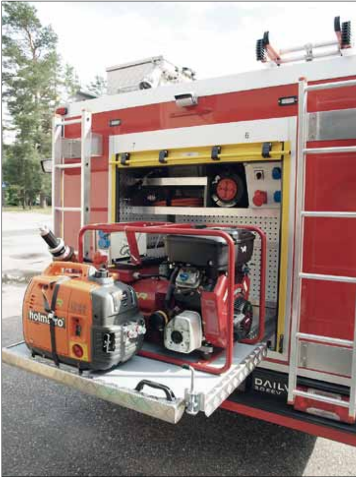
Pelastusvälinekalustokaapissa ovat mm. generaattori, hydraulinen leikkuri ja -levitin.
