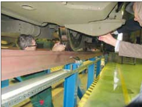
Huoltomies mittaa pyörän profilia käsitulkilla. 2-luokka, ei sekään huono ole.
