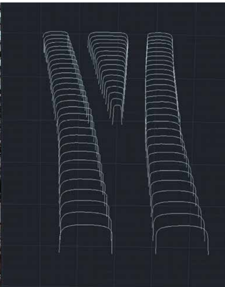
Kuva 3: Mitattua risteystä vastaava risteysmalli profiilimittauksista
