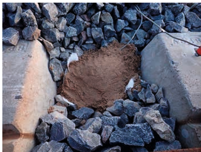
Kuva 2. Kiihtyvyyssantureihin perustuva siirtymämittaus ratapölkyn päästä ja pölkkyjen välistä. Kuvat Tommi Rantala.
