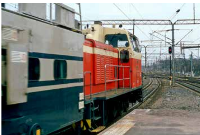
Kuva 7. Raideopastin näyttää aja-opastetta vaihtoyksikölle. (Tero Sorsimo)
