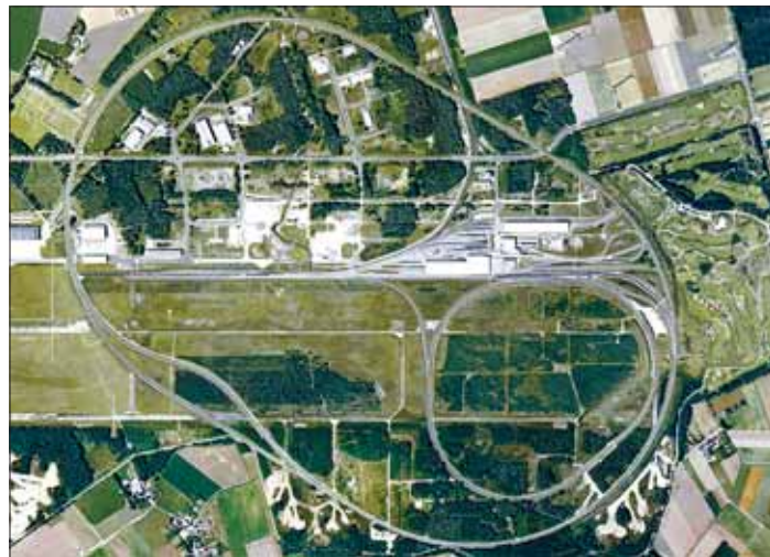
Siemensin Wildenrathin 28 kilometrin testiradalla voidaan Galileo-satelliitin paikannusjärjestelmää testata junissa turvallisesti ja aidoissa maasto-olosuhteissa.
