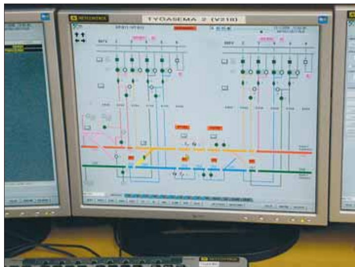
Metron 750 V syöttöasemat ja virtakiskon ryhmien ohjaus.
