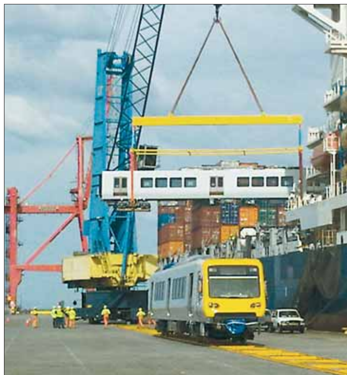
Myös Australiassa käytetään Alstomin X'Trapolis-sähkömoottorijunia. Kuvassa Italiassa valmistettuja vaunuja puretaan Melbournen satamassa.
