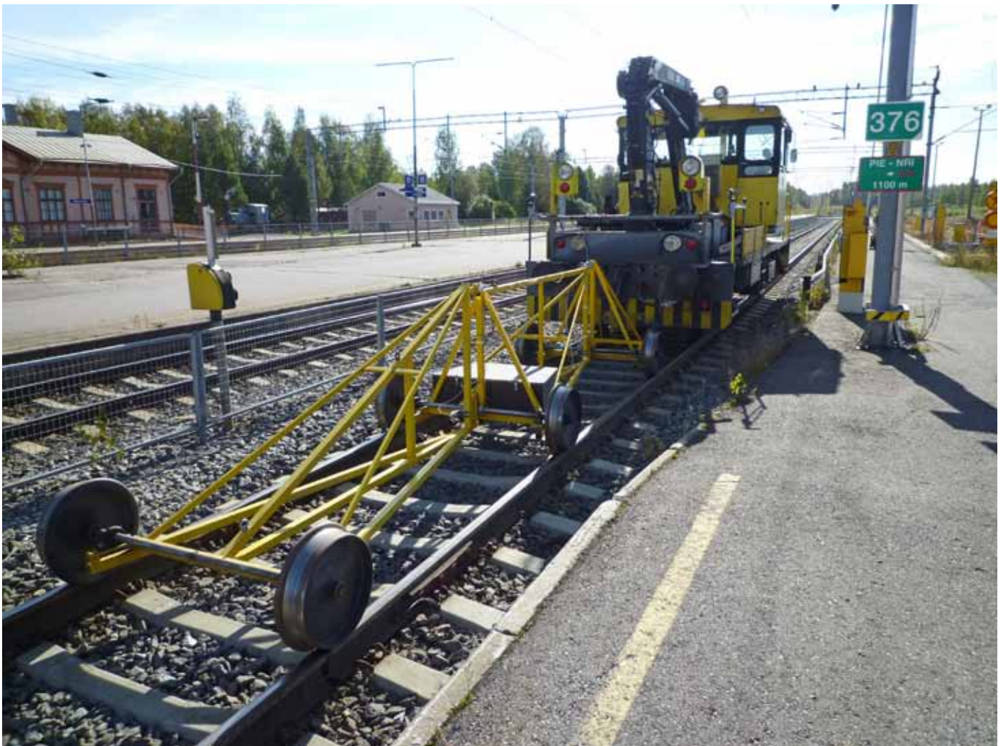
Kuva 2. Radan joustomittaukseen kehitetty mittalaite, joka on kiinnitetty ratakuorma-autoon.
