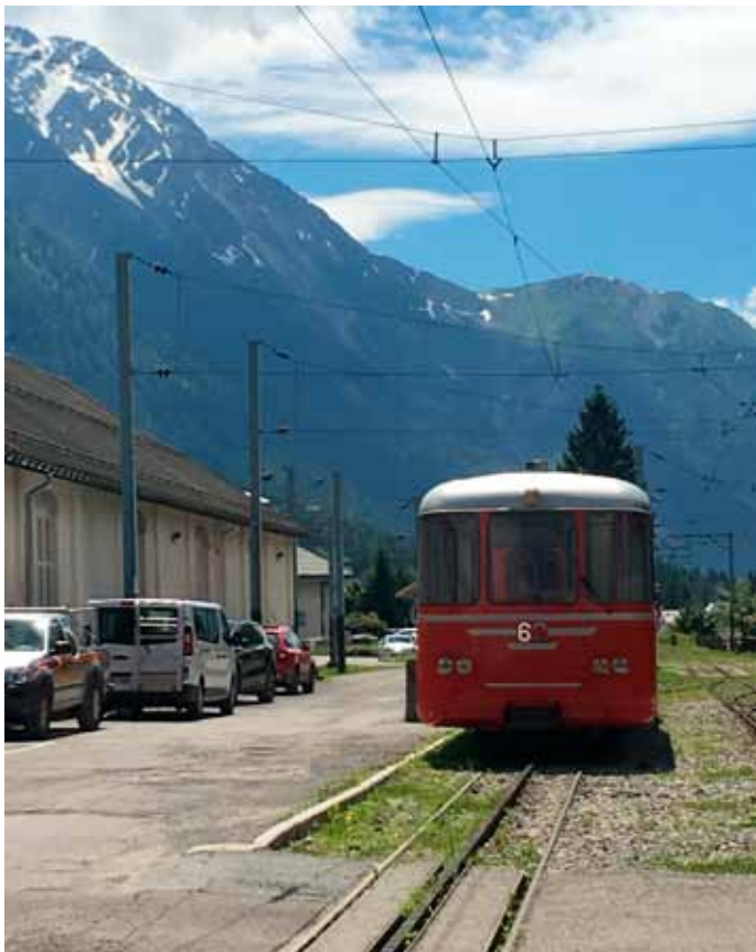
Juna odottamassa lähtöä asemalta, jyrkkien kaltevuuksien vuoksi tarvittava hammaskisko näkyy raiteen keskellä.
