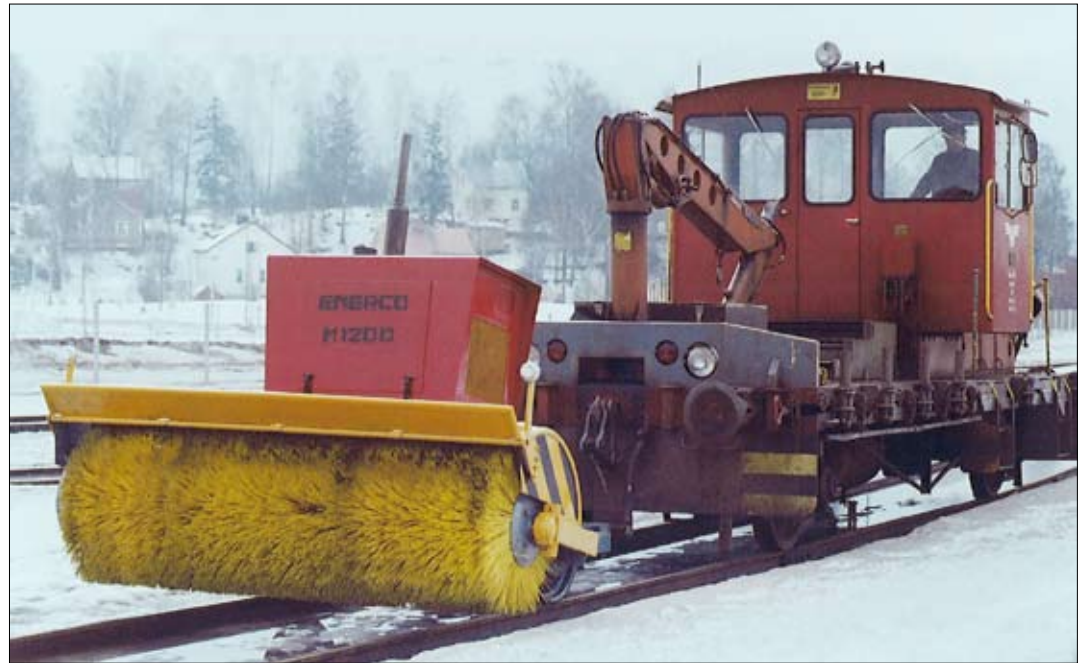
Mankinen Energo 1-akselinen vaihtepuhdistusharjakone ja Tka 6 Ratakuorma-auto alkuperäisessä väriyössään.
