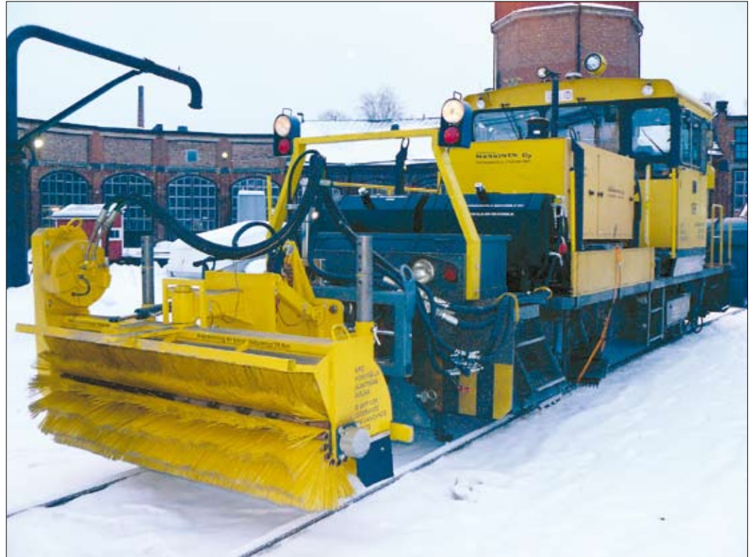
Muutostyönä rakennettu harjakone joka kiinnitetään suoraan Tka:n puskinlevyssä oleviin Valmet-auran pikakiinnityslaitteisiin.
