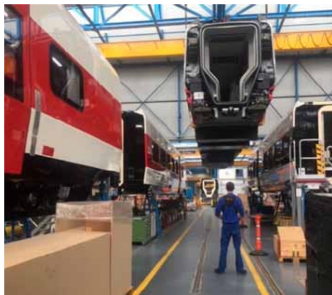
Stadlerin kokoonpanohallissa kauko-ohjataan junarunkoja.
