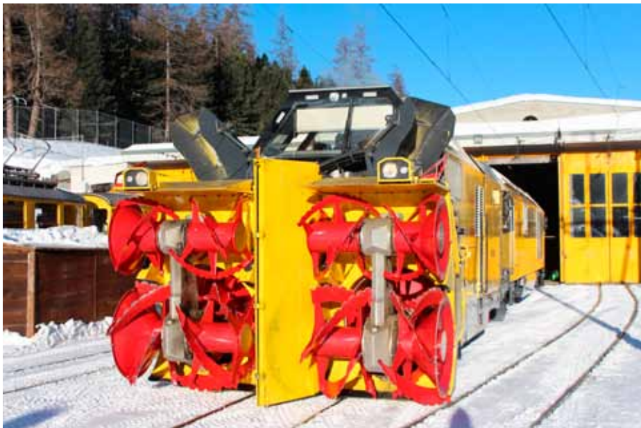
RhB:n Xrot mt 95404 -linko 3,6 metrin lumenpoistoasennossa.
