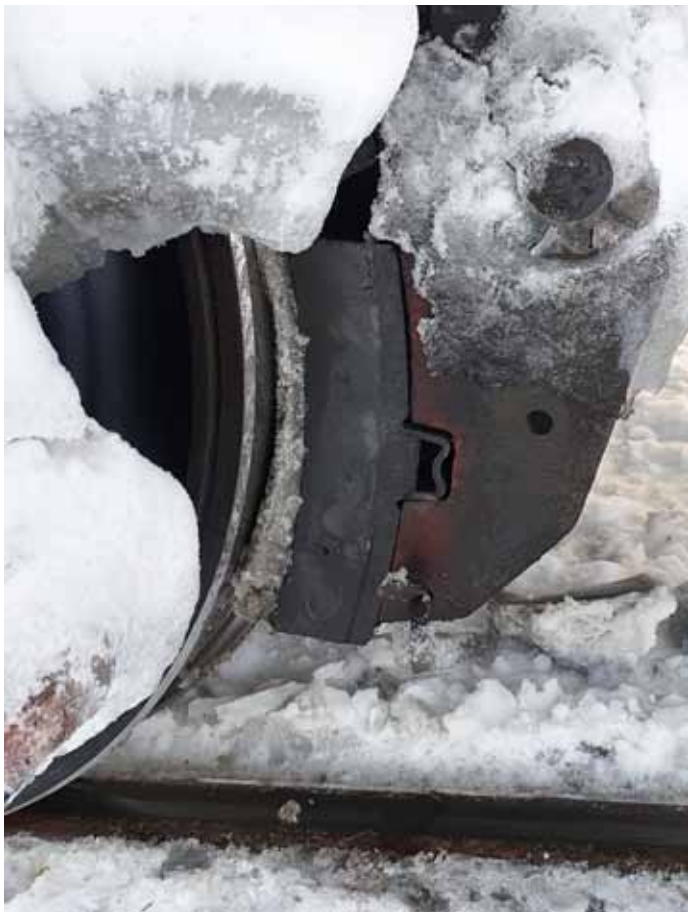
Jarruanturan ja pyörän väliin kertynyttä lunta ja jäätä. Jarruantura on LL-tyyppin UIC-hyväksytty C952-1 -antura. Telin tyyppi on Y25.
