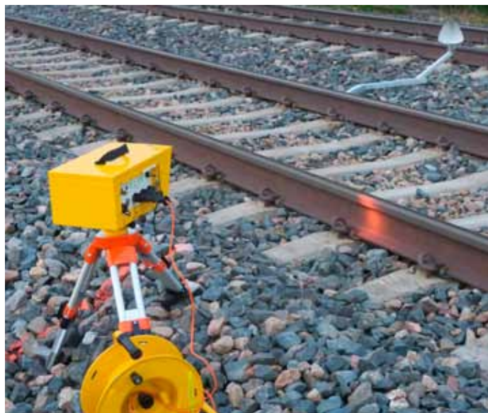
Tutka ja tutkaheijastin asennettuna Järvelässä. Kuva: Teijo Saalasti.
