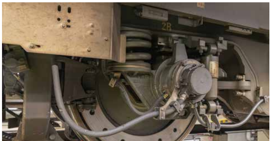
Kuljettua matkaa mittaavat 92 pulssia pyörän kierroksesta tuottavat HaslerRailin odometrit on asennettu kuvassa näkyvän toisen akselin oikeaan päähän ja kolmannen akselin vasempaan päähän. Kuva 14.1.2021 veturi 3315, Ari Julku.
