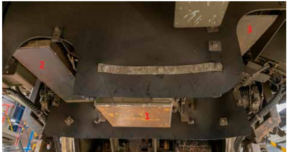
Veturin ykköspään puolella olevan Siemensin ETCS-antennin (1) vieressä vasemmalla on Siemensin valmistama tutka (2) ja oikealla on Deutan valmistama tutka (3). Kuva 14.1.2021 veturi 3315, Ari Julku.
