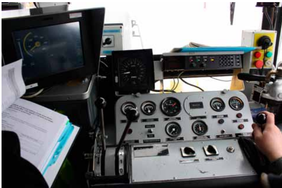
ERTMS-järjestelmään kuuluvaa ETCS-kulunvalvontaa testataan myös Suomessa. Ensimmäiset koeajot ajettiin kuvan Tka7-ratakuorma-autolla. Tämän jälkeen siirryttiin Sr2-veturiin ja 2015 ohjelmassa ovat testit Sr3-koeteturilla.
