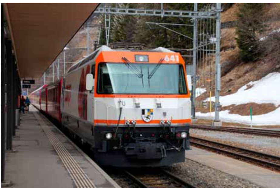
Ge 4/4 III -veturit vastaavat ohjauselektronikaltaan SBB:n 460-vetureita, mihin perheeseen kuuluvat myös VR:n Sr2-veturit. Kuva Kalle Renfeldt
