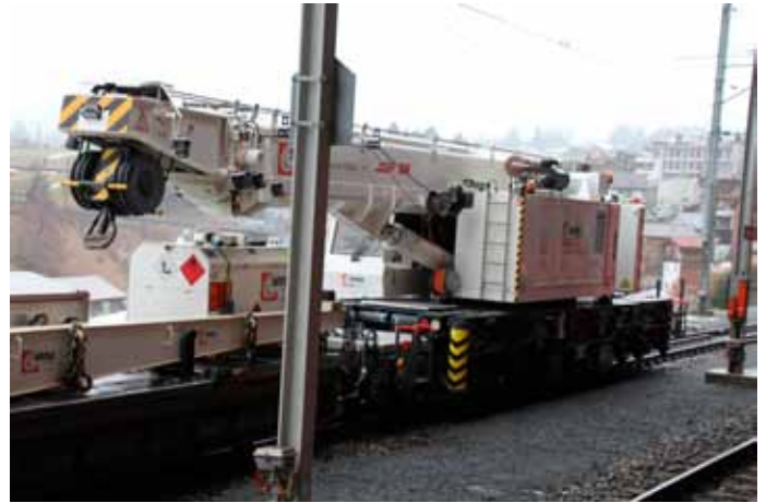
RhB:llä käytössä oleva Sersan Kirow-rautatienosturi. Kuva Kalle Renfeldt
