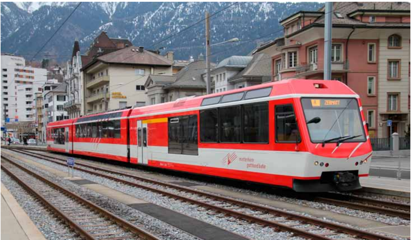
MBG:n uusi ABDeh 4/8 2022 lähiliikenteen moottorijuna. Yhtiöllä on kahdeksan näitä 2008-2014 hankittuja matalalatti- allisia panoraamaikkunoilla varustettuja junia. Pidemmän mat- kan junat ajetaan veturivetoisina. Kuva Kalle Renfeldt
