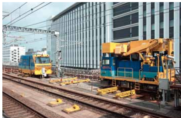
Tokaido-Shinkansenin työkoneita Kioton päärautatieaseman laiturin päädyssä. Ajoneuvot saadaan öisen liikennekatkon alkaessa helposti ja nopeasti nostettua kiskoille.
