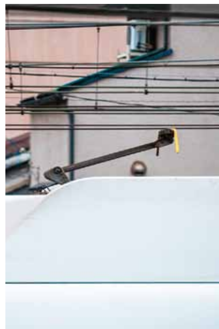
N700-Shinkansenin yksihiilinen virroitin.
