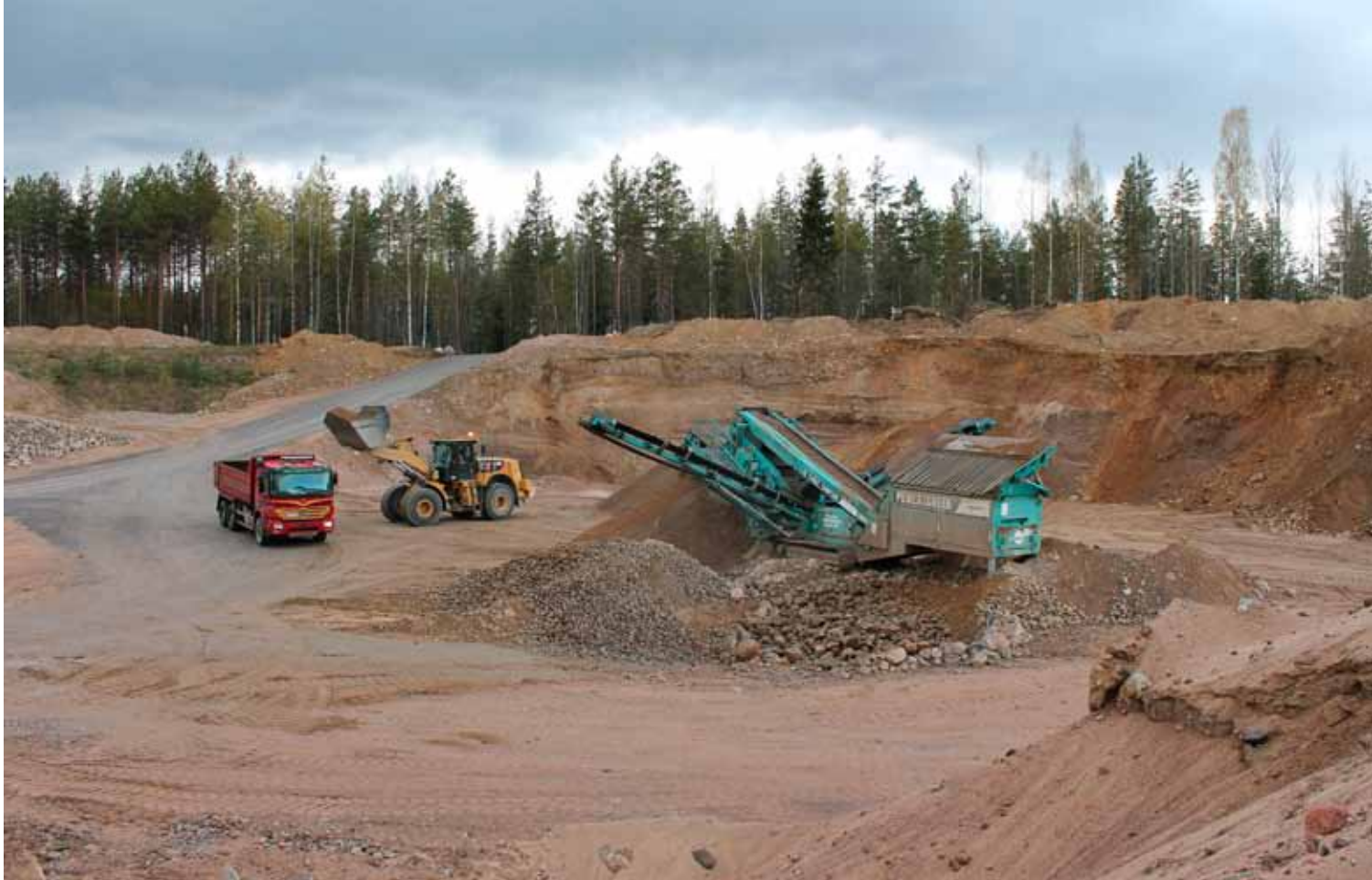
Kuva 2. Eristyskerroksen materiaalin valmistusta seulomalla. Luonnon lajittamassa esiintymässä rakeisuus vaihtelee merkittävästi sijainnin ja syvyyden mukaan.
