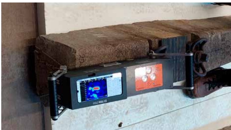
Kuva 2. Betoniratapölkyn kunnan arviointia ultraäänitomografian avulla. (Kuva: Heikki Luomala)
