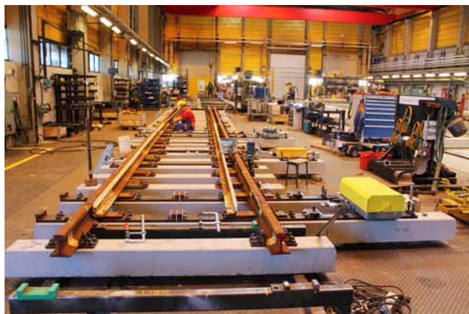
Kuva 3: 60E1-vaihteen kielisovituselementti kokoonpanossa Pieksämäellä.
