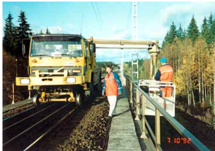
Kuva 4. Sillan tutkiminen henkilönostimella vuonna 1992 (Kuva VR Track arkisto).
