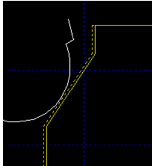
Kuva 2. Tuulettimen sijainti suhteessa pääraiteen aukean tilan ulottumaan
