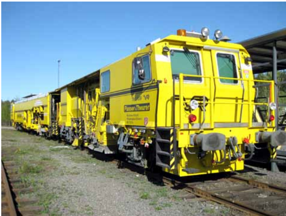
Kuva 3. Vaihteentukemiskone 08-475 UNIMAT 4S.
