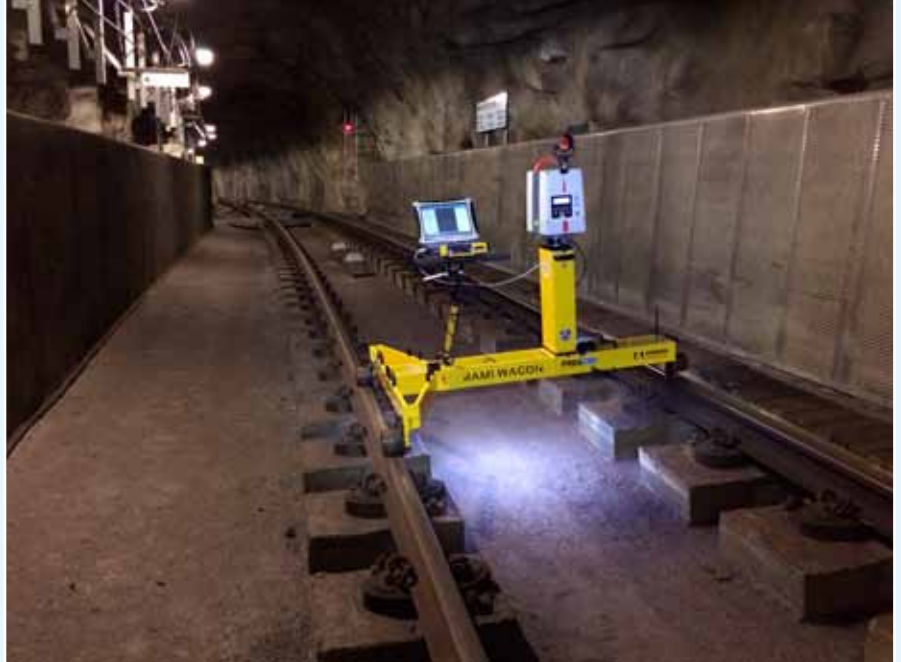
Rami-wagon laserkeilaamassa metrotunnelissa.
