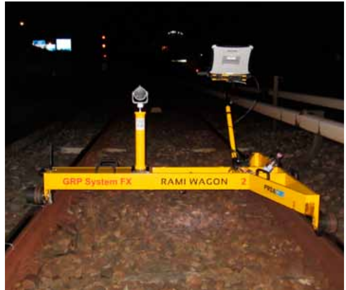
Rami-wagon metroradan geometriamittauksessa.
