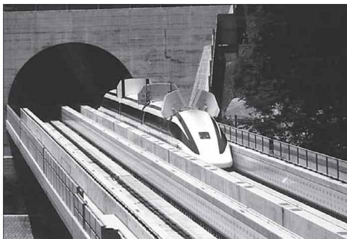
Magneettijuna tulee tunnelista Yamanashin koeradalla Japanissa. Junan siivekkeet ovat jarruttamista varten.
