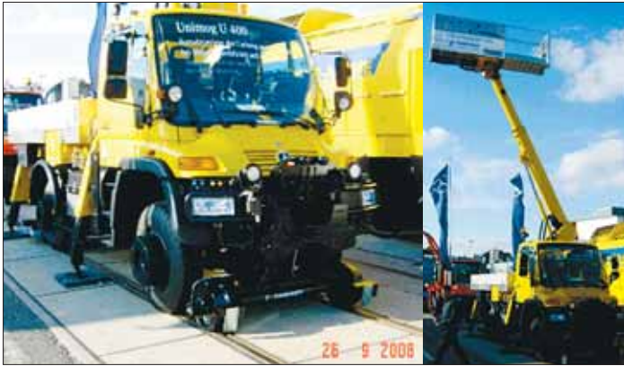
Henkilönostimella varustettu kiskoilla ja pyörillä kulkeva ajoneuvo.
