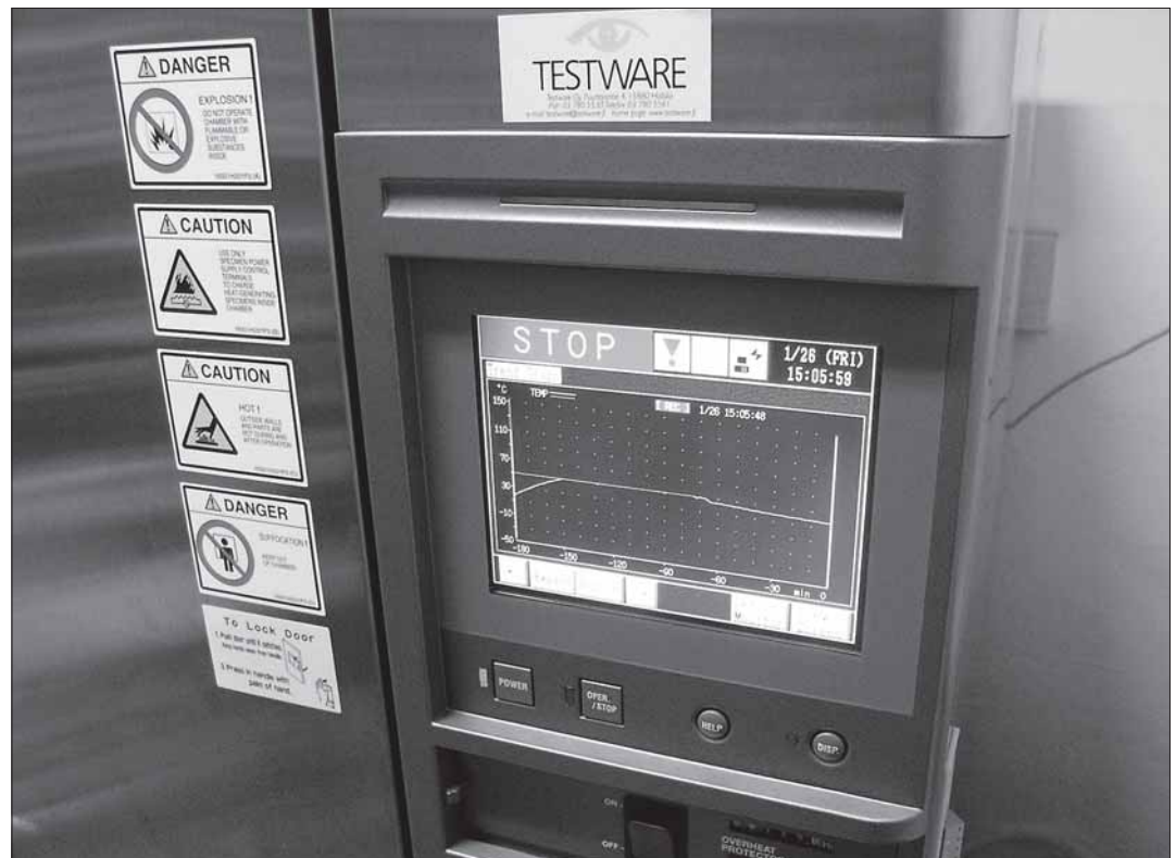
Sääkaapin ohjauspaneeli lämpötilakäyrineen.
