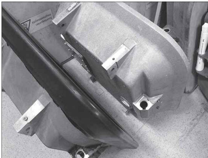
Kuvassa kumitettu ja kumittamaton JKV-antenni.
