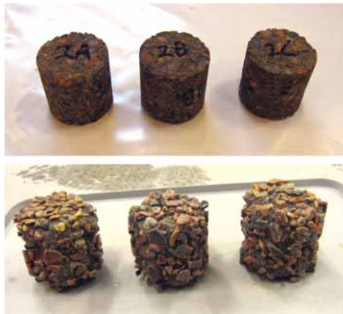
Kuva 4 . Pakkas-suolakoenäytteitä 50 jäädytys-sulatussyklin jälkeen. Ylhäällä kokeessa vähäisesti rapautunut näytesarja Bg7-pölkystä ja alhaalla kokeessa runsaasti rapautunut näytesarja BV69-pölkystä vuodelta 1975.
