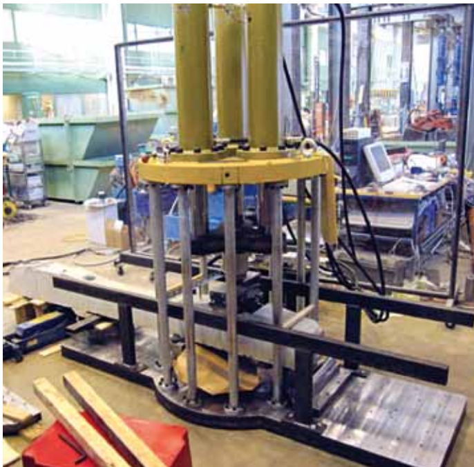
Kuva 2 . Betoniratapölkkyjen kuormittamiseen käytetty kuormituskehä.
