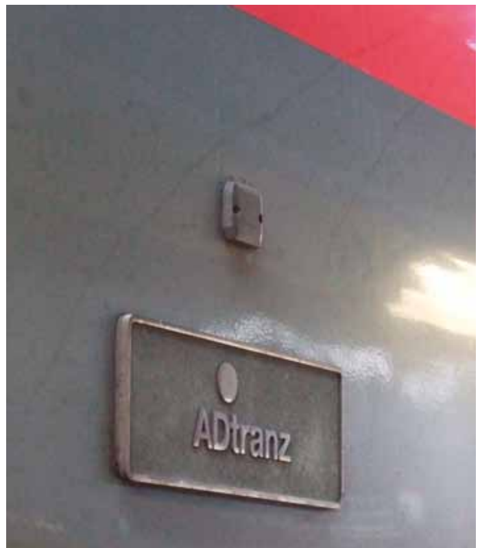
Kuva 3. Confidex Oy:n toimittama RFID-tunniste asennettuna Sr2-veturin valmistajakyltin yläpuolelle.
