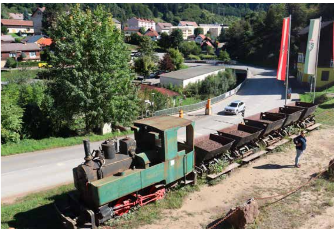
Erzbergin sisäiset kuljetukset tapahtuivat ennen dumperien tieverkostoa kapearaiteisilla radoilla. Krauss & Co:n valmistama veturi (7155/1916) vaunuineen toimii vielä muistomerkkinä kyseisiltä ajoilta.
