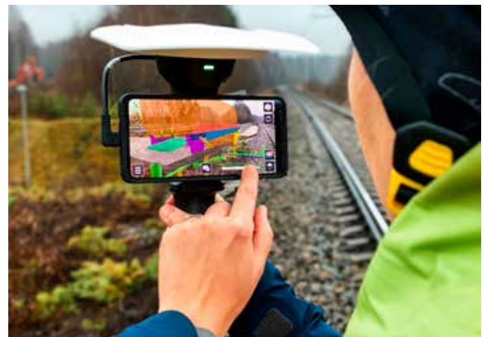
Kuva 2. SiteVision -laitteen käyttöä Joensuun ratapihahankkeella (kuva Jetro Matilainen).
