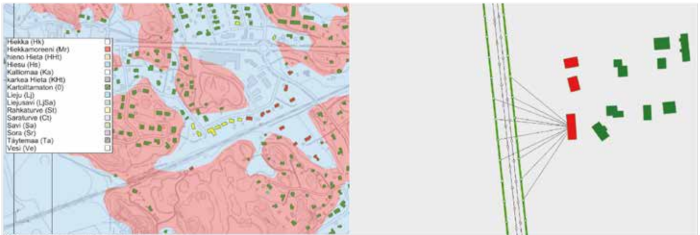
Kuva 2. Työkalun karttapohjaisessa käyttöliittymässä tärinän ja runkomelun laskenta voidaan tehdä niin laajoille alueille kuin yksityiskohtaisempana tarkasteluna.
