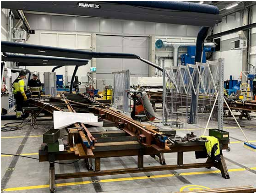
Raitiotievaihteiden kokoonpano käynnissä Euroopan uusimassa vaihdekonepajassa.
