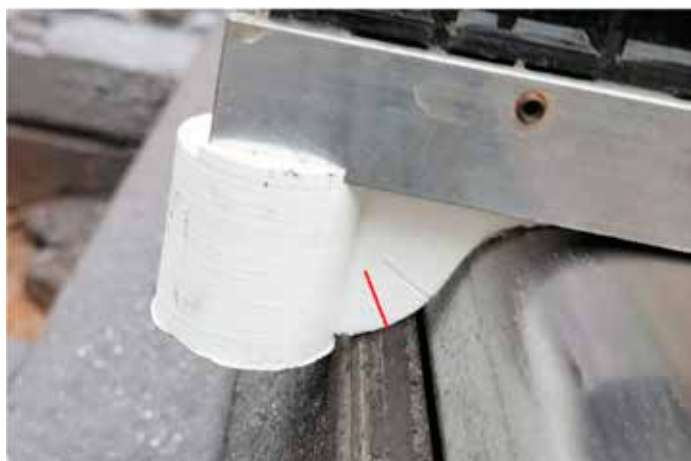
Kuva 1. S1002-mittatulkkin testaaminen vaihteen kielisovitusta vasten todellisen kontaktikulman (punainen viiva) määrittämiseksi.
