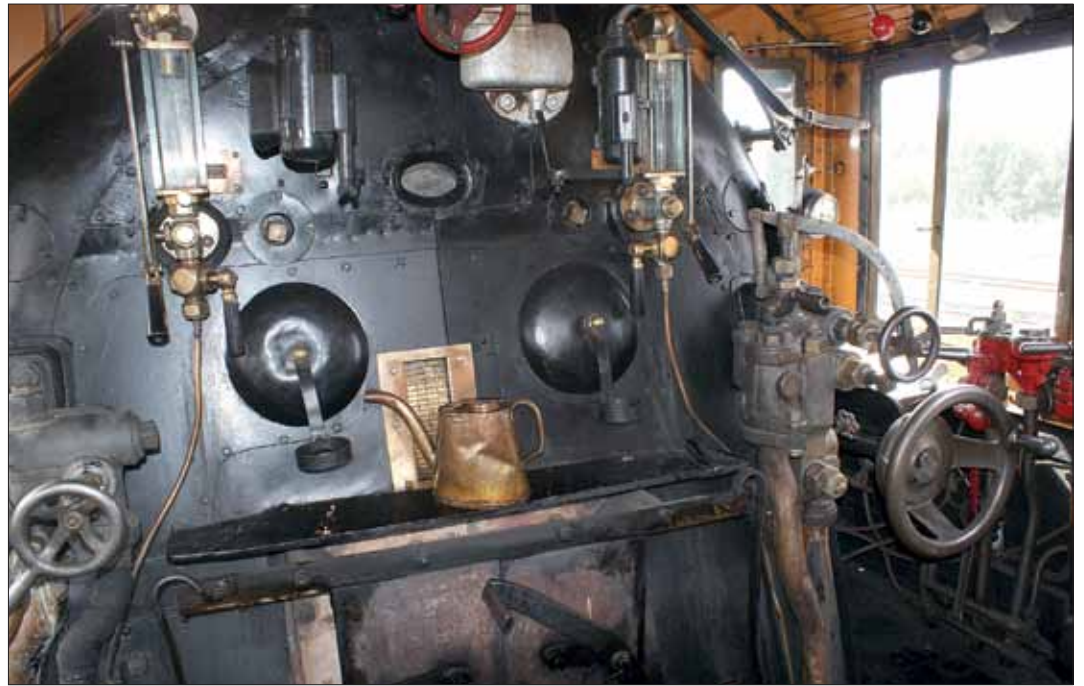
Ukko-Pekan hytissä eli kuljettajansuojuksessa sijaitsevat veturimiehistön, veturinlämmittäjän höyrykattilan hoidossa tarvittavat varusteet että oikealla puolella olevat veturinkuljettajan hallintalaitteet. Kuva: Hannu Saarinen (Hyvinkää 14.8.2011).
