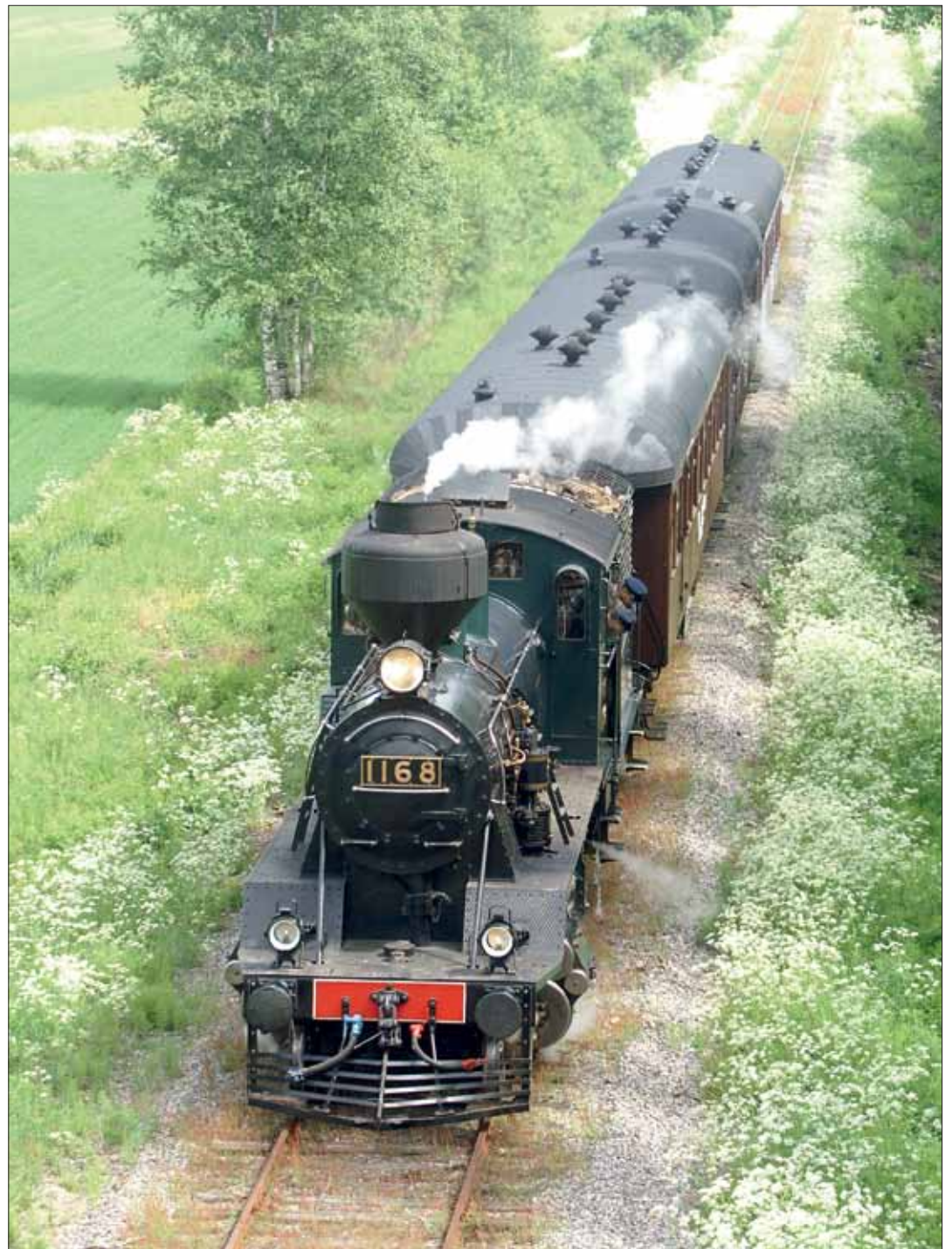
Tk3 (ex K5) nro 1168 Pikku-Jumbo Porvoon museorautatiellä. Näitä kevyitä tavaraliikennevetureita valmistettiin vuosina 1927 – 1953 Suomessa ja Tanskassa. Kuva: Hannu Saarinen (Porvoo 14.6.2008).
