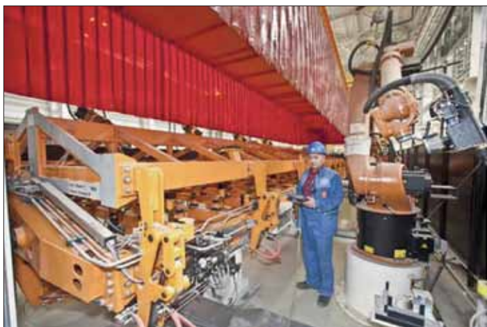
Vaunun sivulaitojen hitsausrobotti Tikhvinin vaunutehtaalla (kuva: TVSZ).
