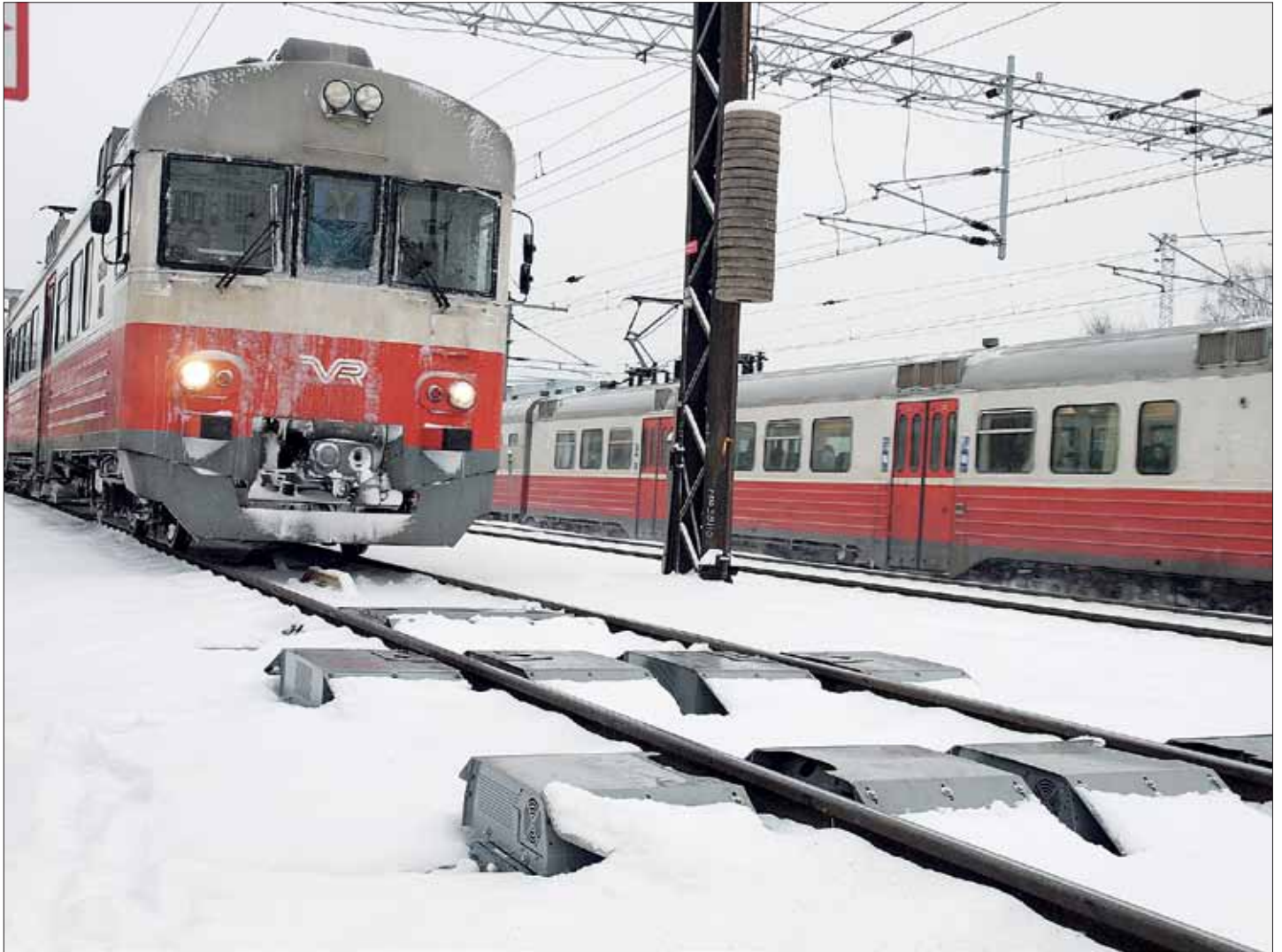
Sm1 runko on jo lovipyöräilmaisimen kohdalla ja edessä ovat vielä pyörän laser-mittaukset.
