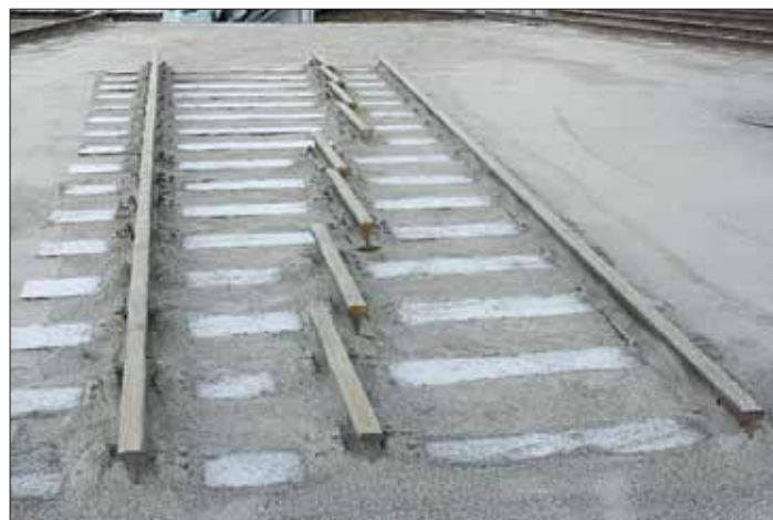
Infranäyttelyssä on esillä mm. tämä raide-elementti, jossa havainnollistetaan raideleveydet 600, 750, 1000, 1067, 1435, 1524, 1600 ja 1668 mm. Oikealla on vain elementin kuljetuksessa käytetty väliaikainen tukikisko, joka on jo poistettu. Näyttelyssä kerrotaan kylteissä kutakin raideleveyttä on käytetty tai käytetään. Kuva Markku Nummelin.
