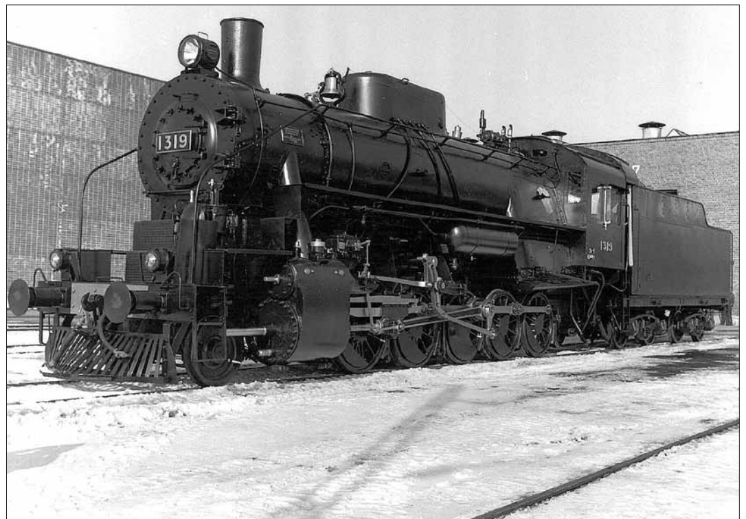
Tr2 Truman nro. 1319, American Locomotive Company, Schenectady 1947. Veturisarja oli varustettu koneellisella hiilensyötöllä eli stokerilla. Kuva: Hyvinkään konepaja 1986.
