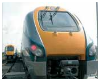
Kaikki kuvassa olevan veturin viisi etuvaloa on toteutettu valodioditekniikalla (LED-valot).
