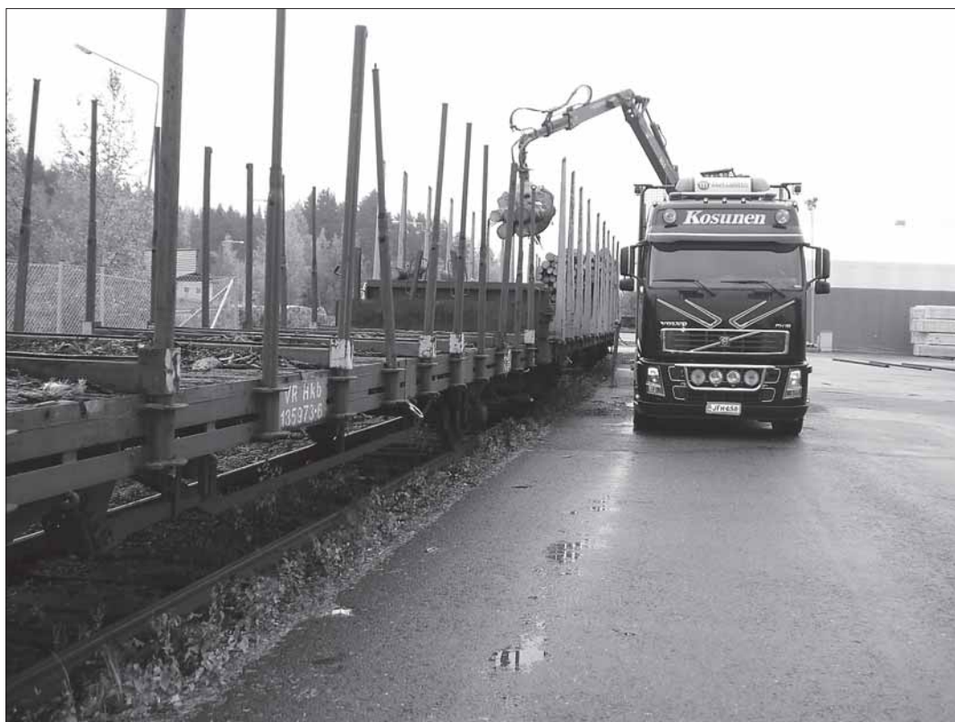
Laivasta puretun raakapuun lastaus vaunuun käynnissä.
