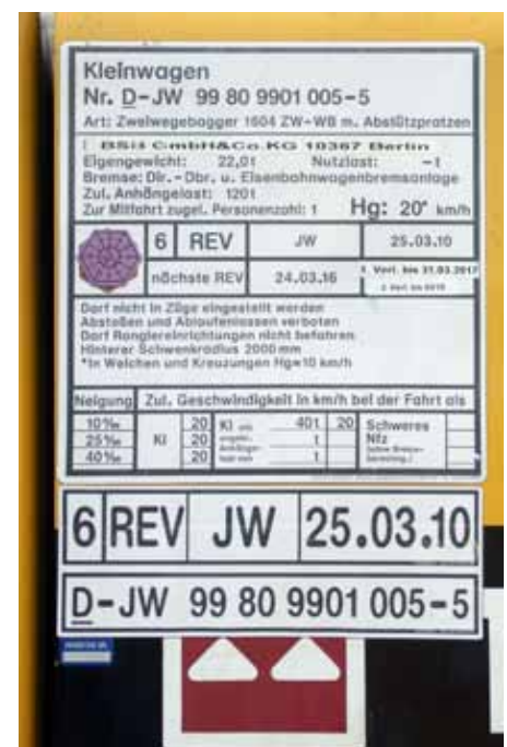
Kuva 3: Saksalaisen kiskopyöräkaivinkoneen hyväksyntätarra numeroineen (Kuva: Seppo Mäkitupa)
