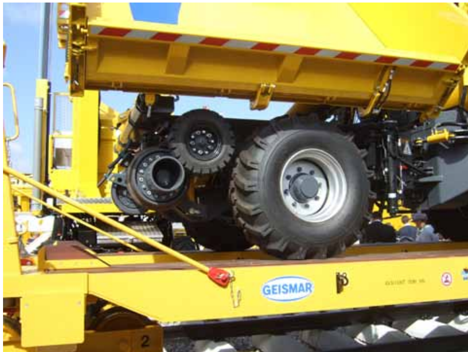
Kuva 4: Luokan 9B kiskopyöräkoneen veto- ja jarrutusvoimat välitetään epäsuorasti (Kuva: Seppo Mäkitupa)
